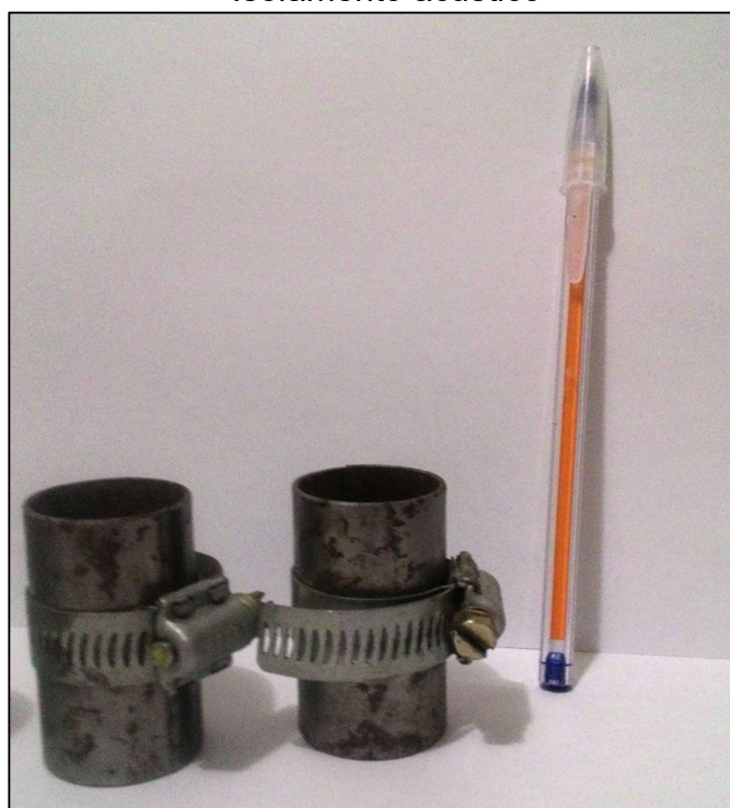
Figura 18- Preparação dos CP's cilíndricos 2,9x5 cm para o ensaio de Isolamento acústico
