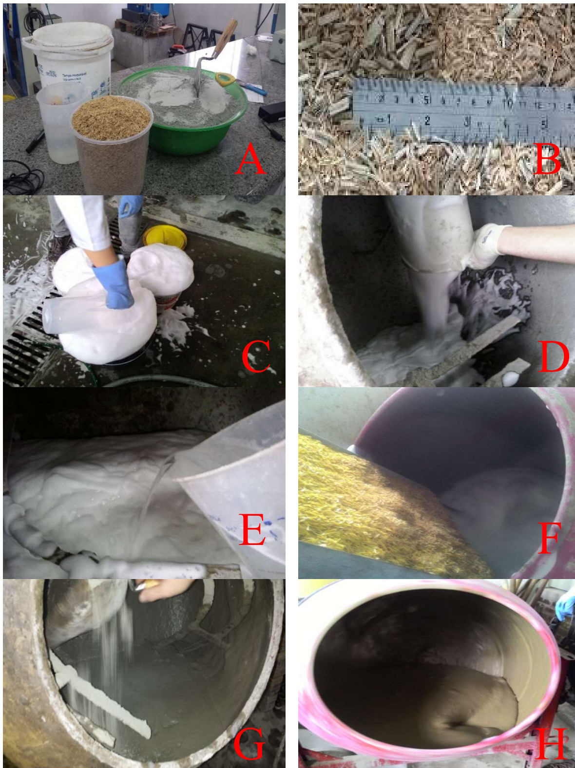
Figura 14- Procedimento de Mistura – (A) Preparação dos materiais; (B) Palha e Casca cortadas nos tamanhos que serão utilizados; (C) Espuma pronta; (D) Colocação da espuma na betoneira; (E) Água sobre a espuma; (F) Colocação das fibras na betoneira; (G) Colocação do cimento na betoneira; (H) Aparência final do material.
