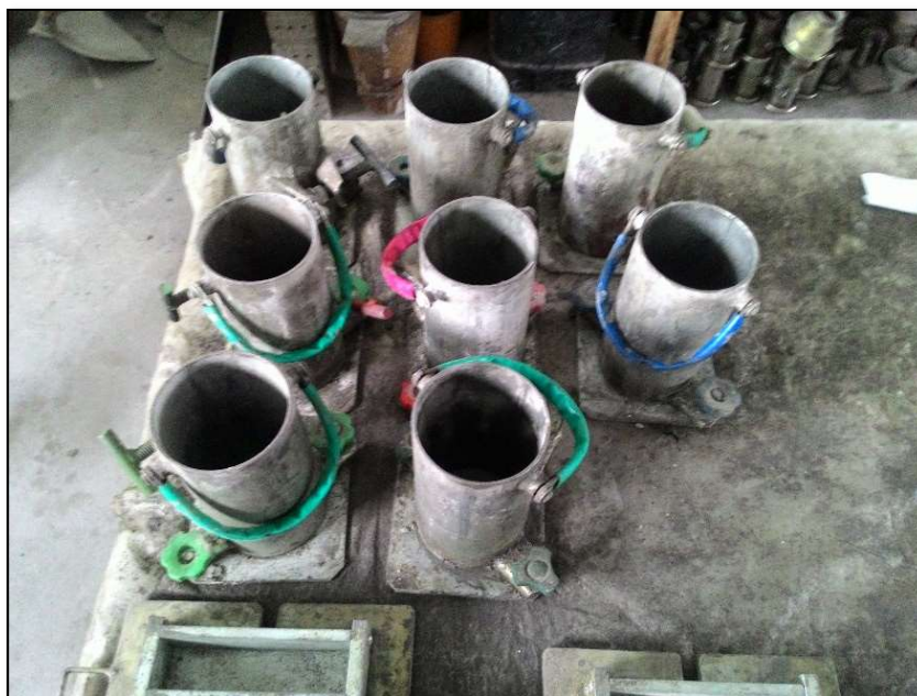
Figura 16- Preparação dos CP's cilíndricos 10x20 cm para ensaio de Resistência à compressão
