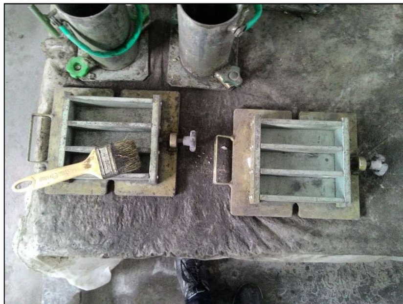
Figura 17-Preparação dos CP's prismáticos 4x4x16 cm para ensaio de Resistência à tração
