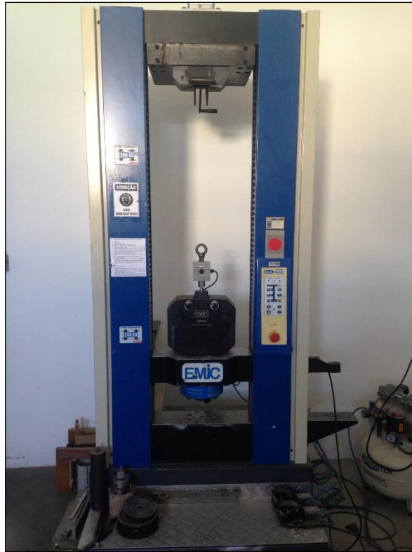
Figura 28 – Prensa para rompimento dos CP's
