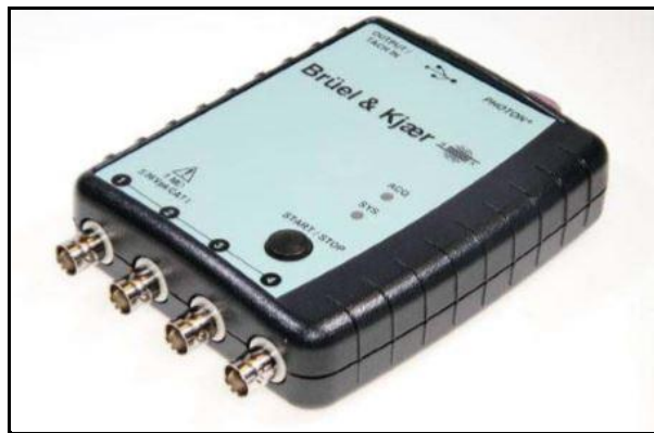
Figura 11- Hardware de captação de sinais.
