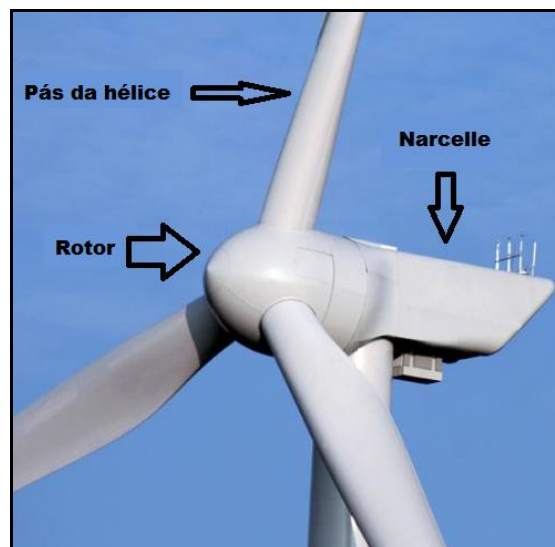
Figura 9- Principais elementos de um aéro gerador.
