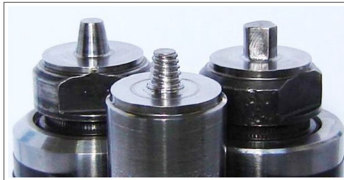
Figura 9 – Geometrias do pino da ferramenta
