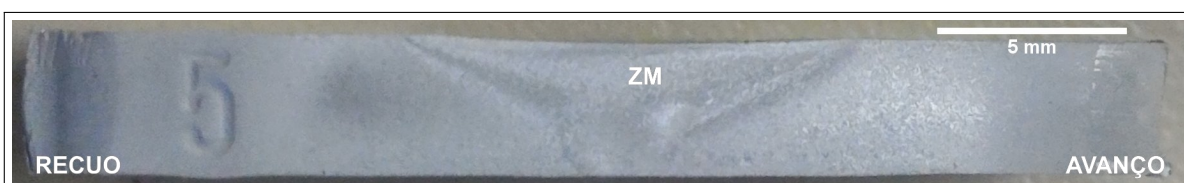
Figura 45 – Macrografia de amostra soldada a 1500 rpm e 50 mm/min
