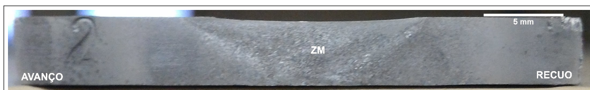
Figura 42 – Macrografia de amostra soldada a 1500 rpm e 30 mm/min
