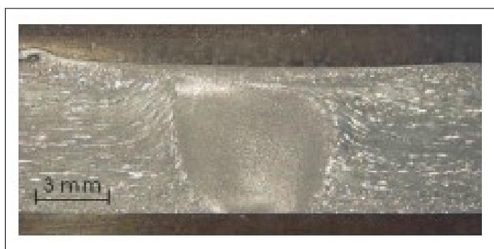
Figura 3 – Macrografia de liga AA5052 soldada pelo processo FSW
