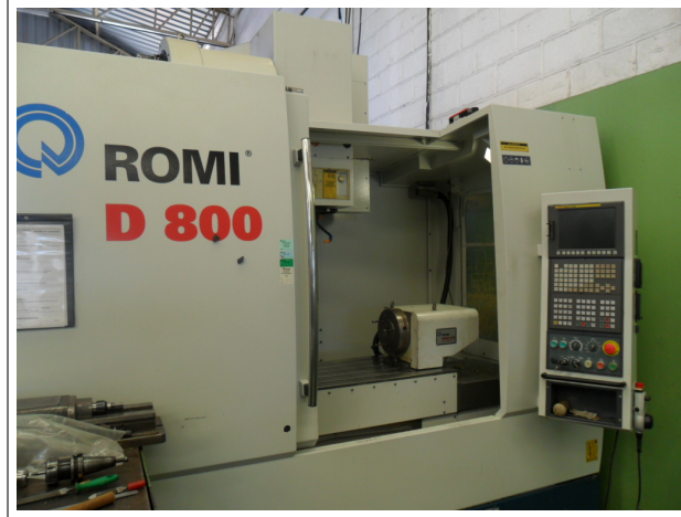
Figura 17 – Centro de usinagem CNC ROMI D 800
