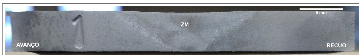
Figura 41 – Macrografia de amostra soldada a 1000 rpm e 30 mm/min
