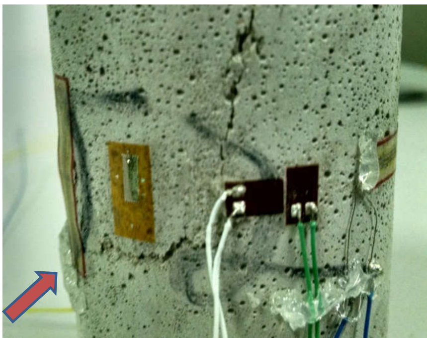
Figura 16 – Fissura atravessando strain gauge
