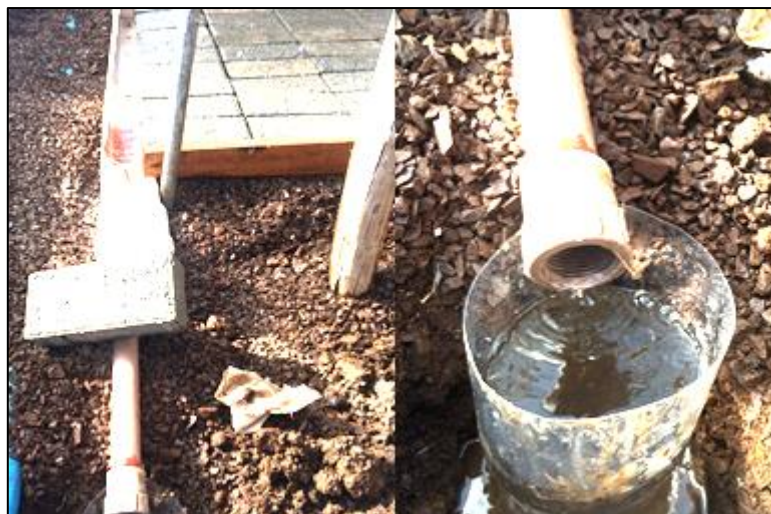
Figura 26 - Sistema coletor do escoamento
