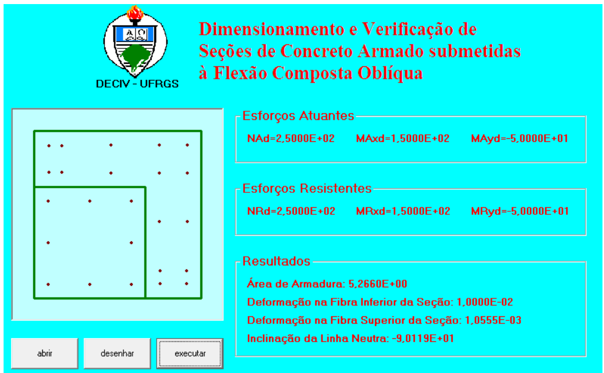
Figura 36 - Seção de reforço implantada na seção original do pilar de concreto armado
