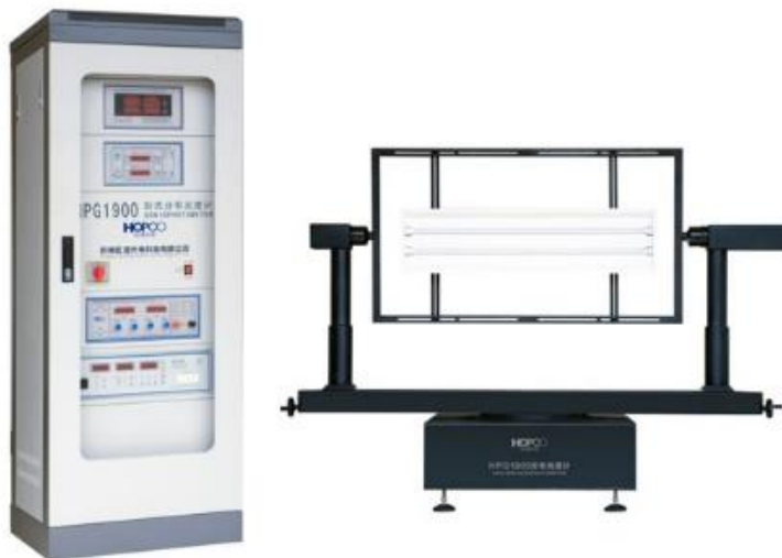
Figura 11 - Partes principais do Goniofotômetro.
