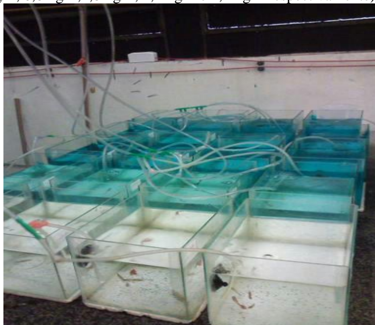
Figura 1. Bateria de teste com concentrações de verde malaquita (0,0mg/L, 0,6mg/L, 1,8mg/L, 1,2mg/L e 2,4mg/L respectivamente).
