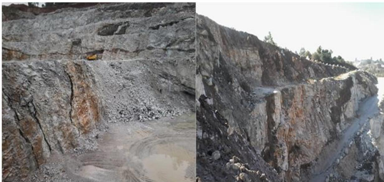
*Figura 3: Depósito da cava Linhares (empresa A) e Mangueirão (empresa B), onde é possível observar a grande heterogeneidade do maciço, com a presença de diversas descontinuidades geológicas.*
