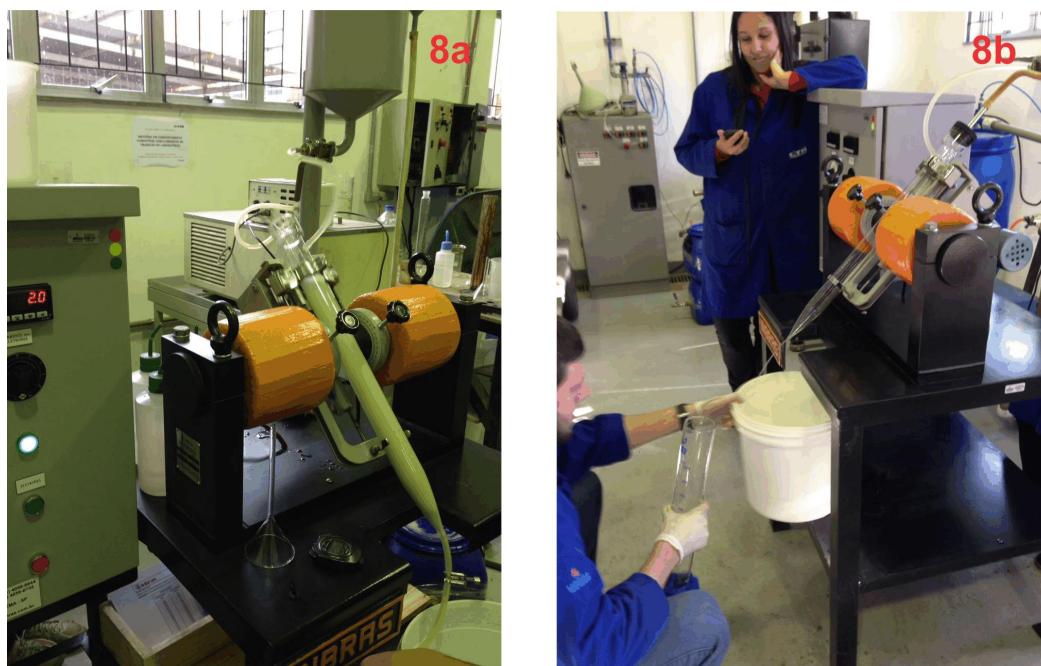
Figura 8 – (a) Tubo Davis operando durante a separação e (b) coleta do material e lavagem do tubo após separação magnética.
