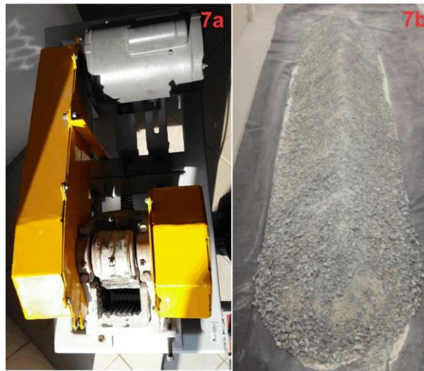
Figura 7- (a) Vista superior do britador de mandíbulas Lombard, (b) homogeneização da pilha do minério.
