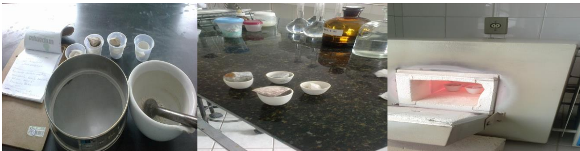
Figura 6 – Etapas de preparação das amostras para calcinação no forno Mufla.
