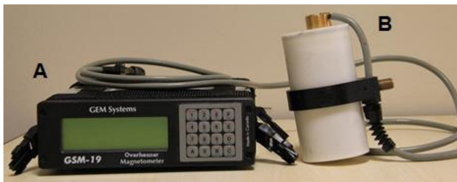
Figura 8 – Conjunto magnetômetro modelo GSM - 19 utilizado no levantamento de dados terrestres com o módulo de aquisição de dados (A) e sensor (B).
