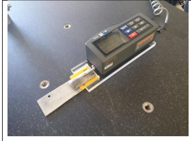
Figura 29 - Corpo de prova e equipamento de ensaio de rugosidade.
