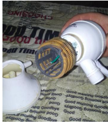
Figura 8- Desmontagem de um chuveiro elétrico.
