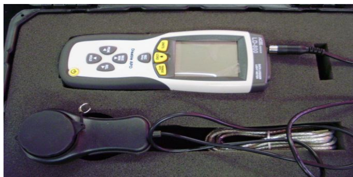
Figura 13: Luxímetro Digital ICEL LD-800 Aferido com Certificação.
