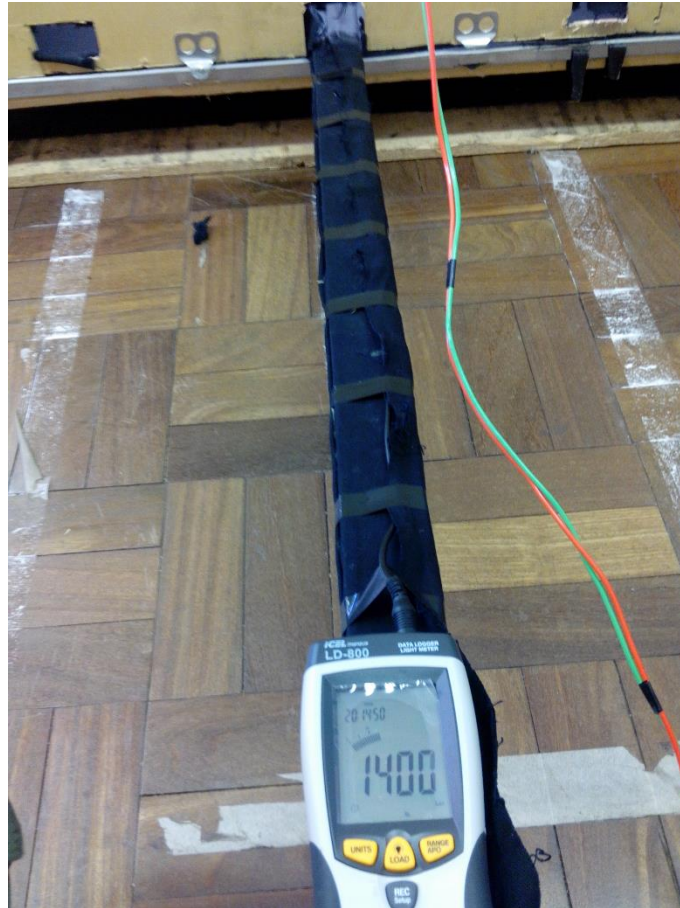
Fig. 3.26. Medição no Centro do Equipamento: abaixo da lâmpada
