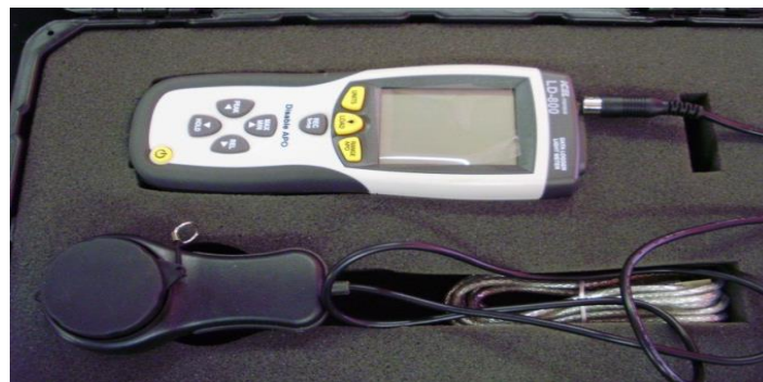
Fig.2.9. Luxímetro Digital ICCEL LD-800 Aferido com Certificação INMETRO
