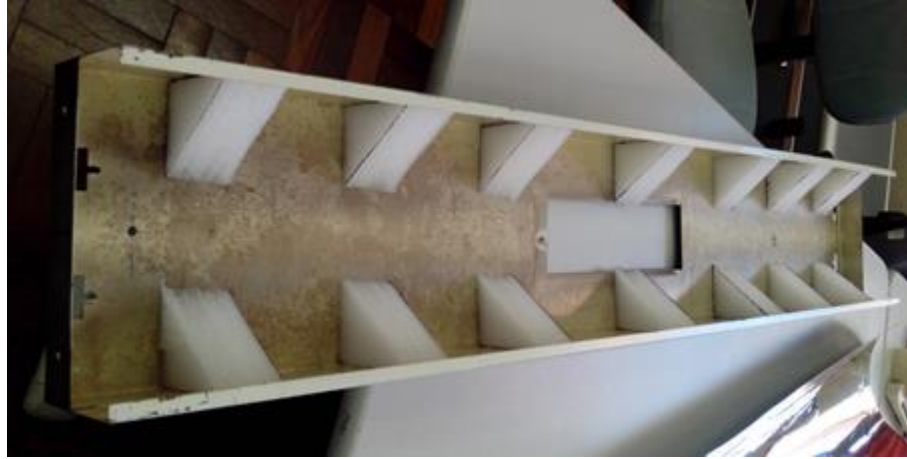
Fig. 3.23. Moldes do Refletor ao longo da Calha
