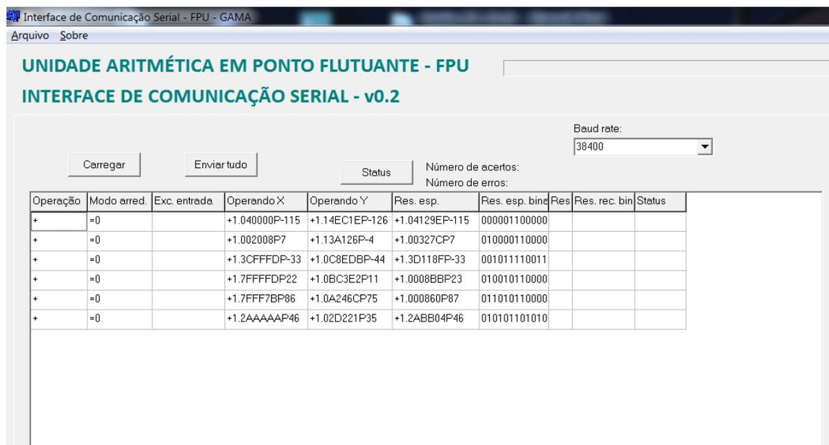
**FIGURA 61 - Interface gráfica do software para a comunicação serial.**
