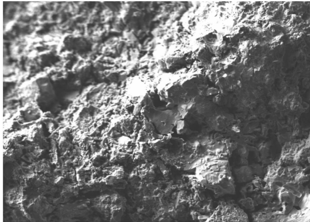
Figura 48 - Micrografias 10 CCA 5LETA em MEV com magnitude de 500x e 1000x
