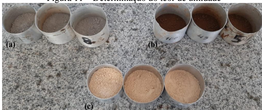
Figura 11 – Determinação do teor de umidade
