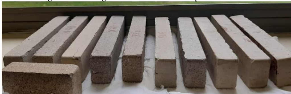
Figura 25 – Secagem dos CPs ao ar livre após resfriamento
