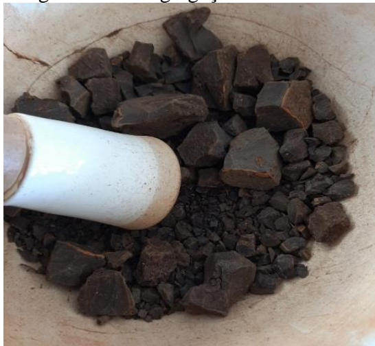
Figura 7 – Desagregação do Lodo ETA
