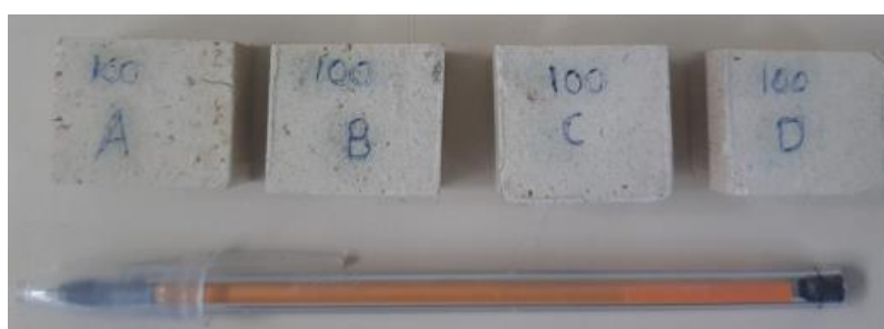
Figura 21 – CPs com dimensões reduzidas para ensaio de resistência à compressão
