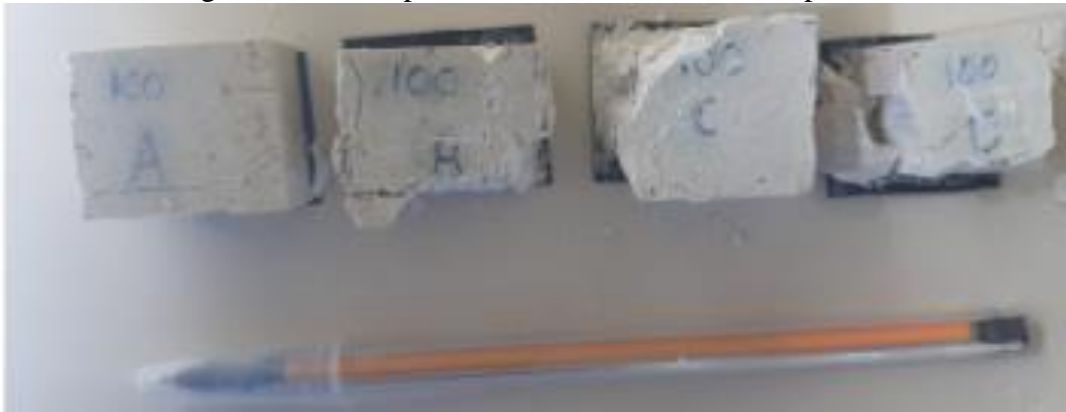
Figura 42 – CPs após ensaio de resistência à compressão
