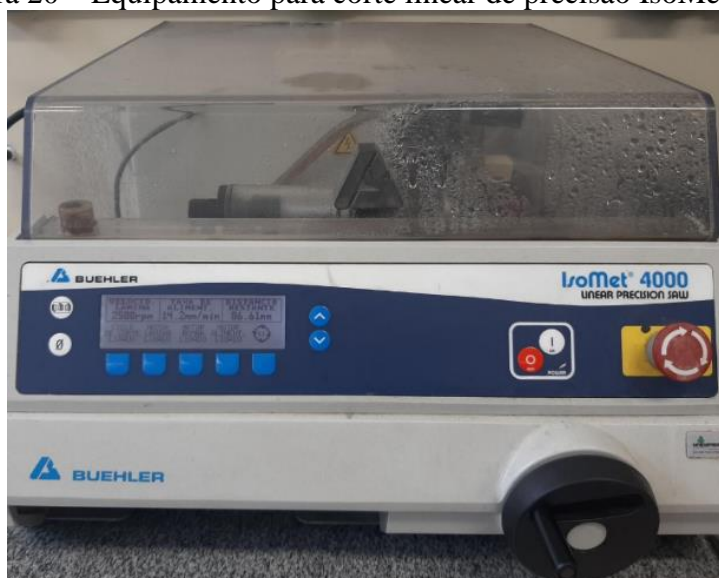
Figura 20 – Equipamento para corte linear de precisão IsoMet 4000
