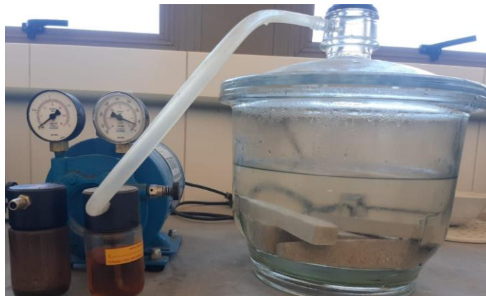
Figura 18 – Equipamento utilizado para realização do ensaio de DMA, PA e AA.
