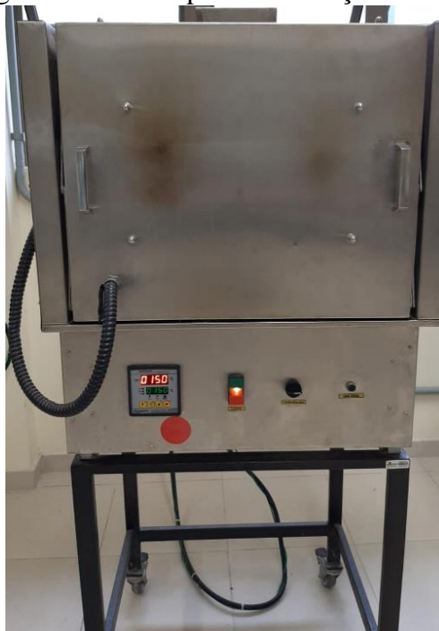
Figura 16 – Forno para sinterização dos CPs
