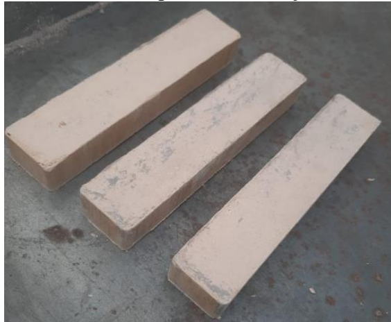
Figura 12 – Amostras testes para determinação do teor de umidade
