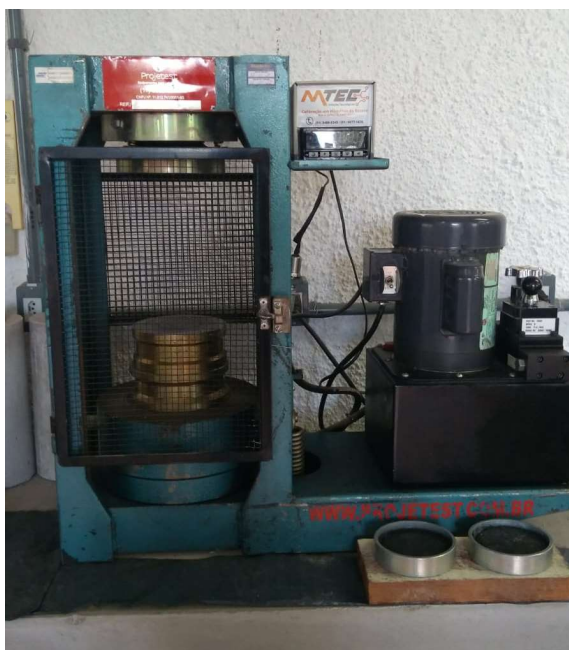
Figura 14 – Prensa para rompimento de corpo de prova de concreto.
