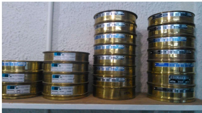
A Figura 12 – Peneiras para classificação granulométrica
