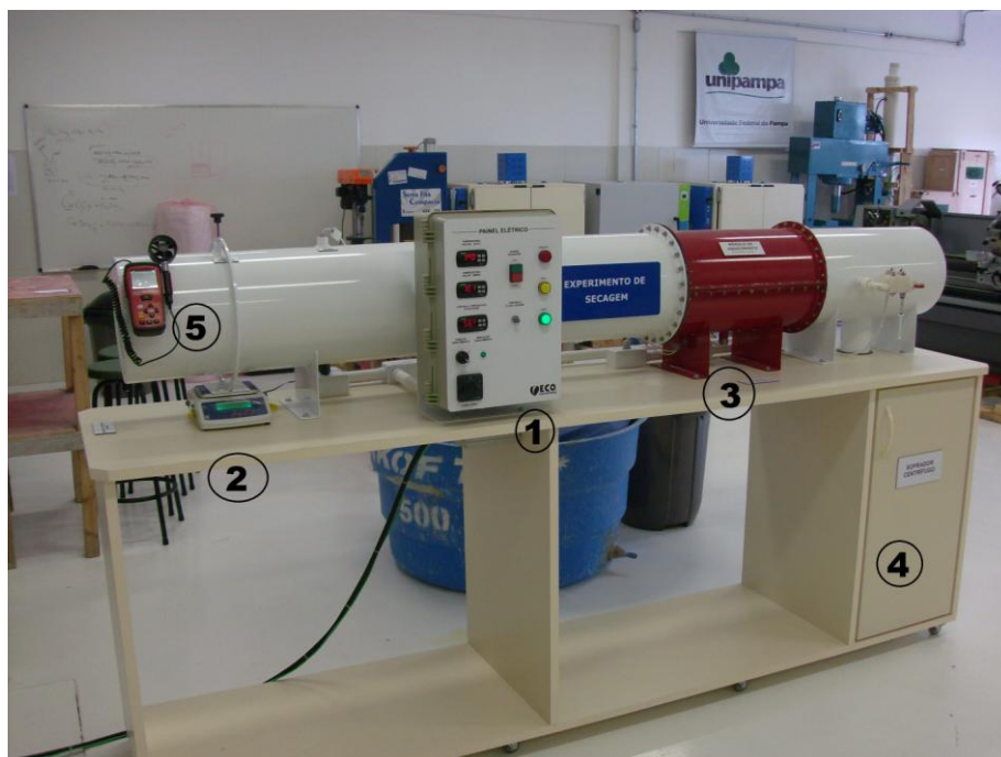
Figura 4.2 – Secador de Bandejas com Escoamento em Paralelo. 1) Sistema de Controle do Secador 2) Balança 3) Resistências elétricas 4) Soprador Centrífugo 5) Anemômetro.
