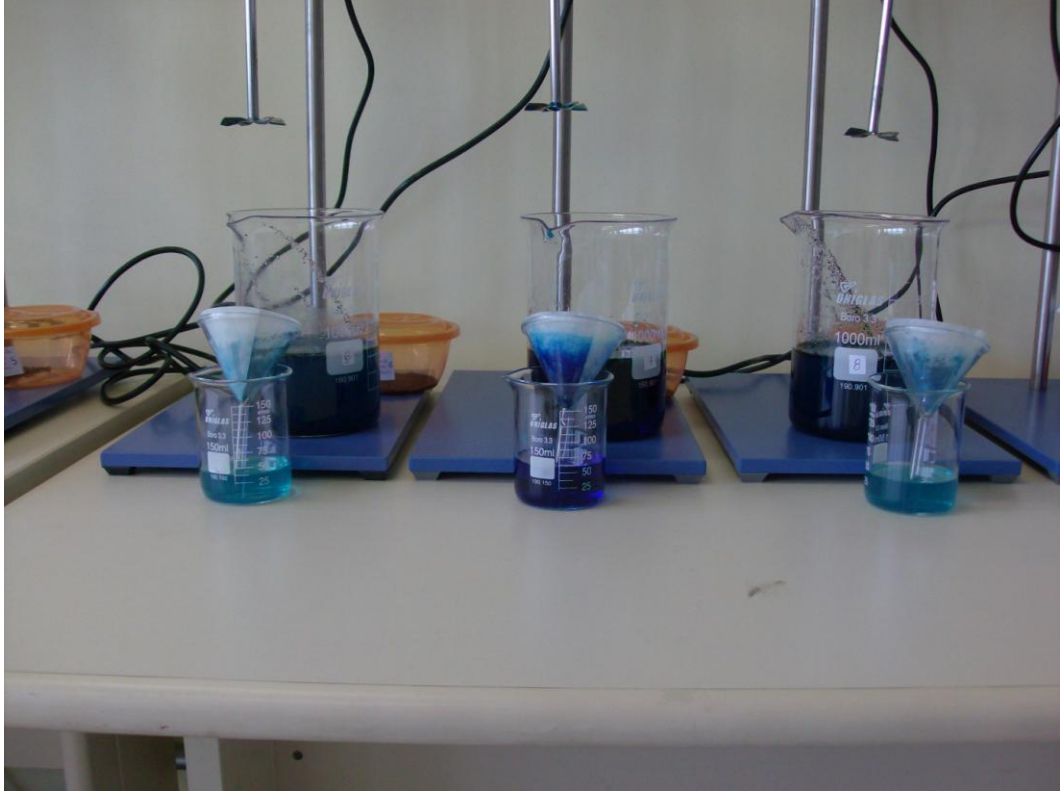
Figura 4.9 – Tratamento do efluente – etapa de filtração.
