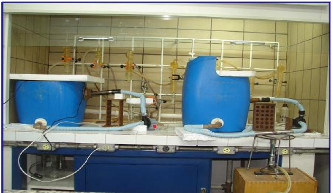
FIGURA 3.6- Sistema montado para testes de procedimentos de limpeza química. (Fonte: Acervo técnico CGTEE).
