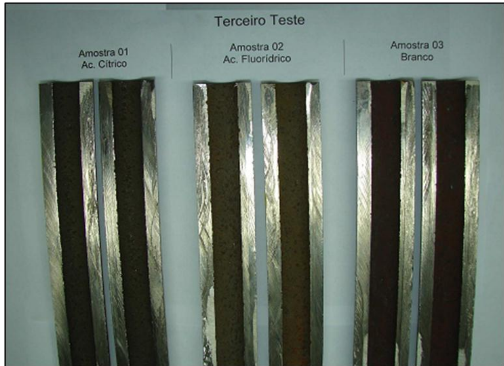
FIGURA 3.9 – Amostras dos tubos após o corte do terceiro teste. (Fonte: Acervo técnico da CGTEE).
