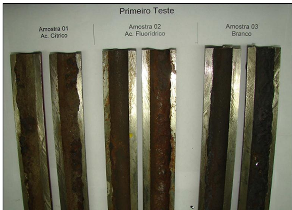
FIGURA 3.7– Amostras dos tubos após o corte do primeiro teste. (Fonte: Acervo técnico da CGTEE).
