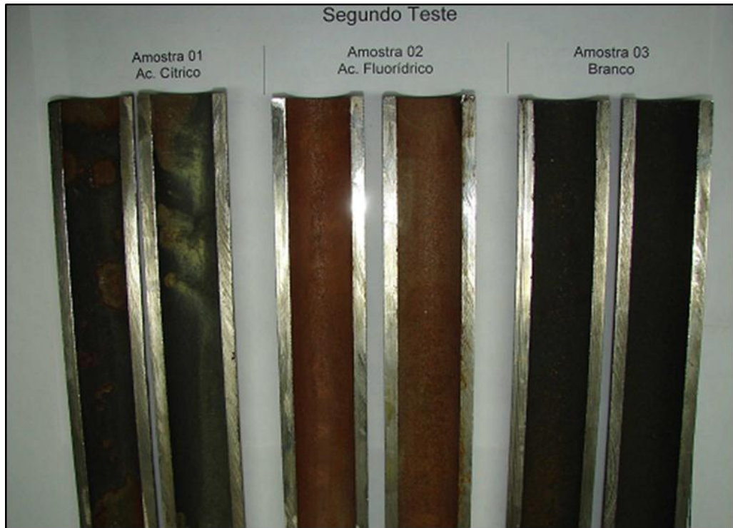
FIGURA 3.8 – Amostras dos tubos após o corte do segundo teste. (Fonte: Acervo técnico da CGTEE).
