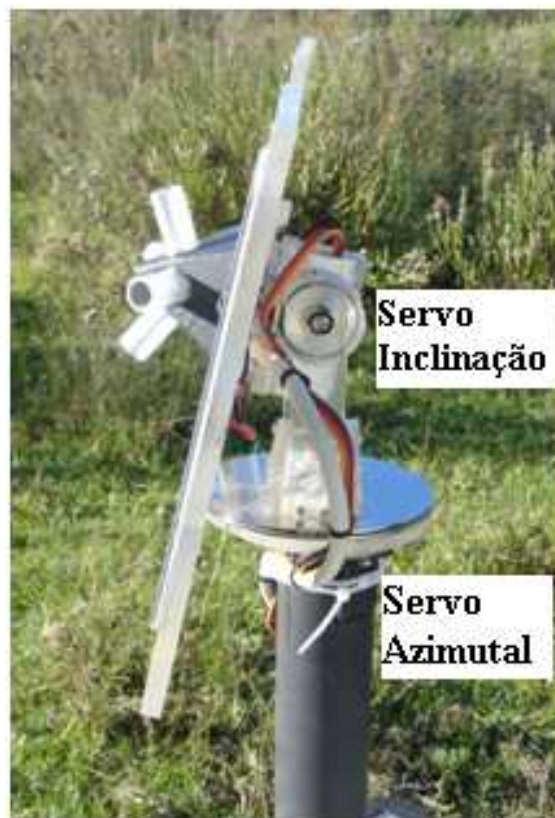
Figura 37 - Estrutura de movimentação Fonte: Autoria própria.
