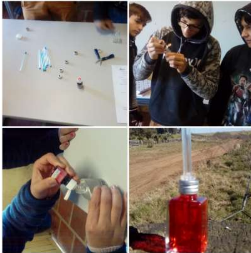
Figura 14 - Construção do Termoscópio
