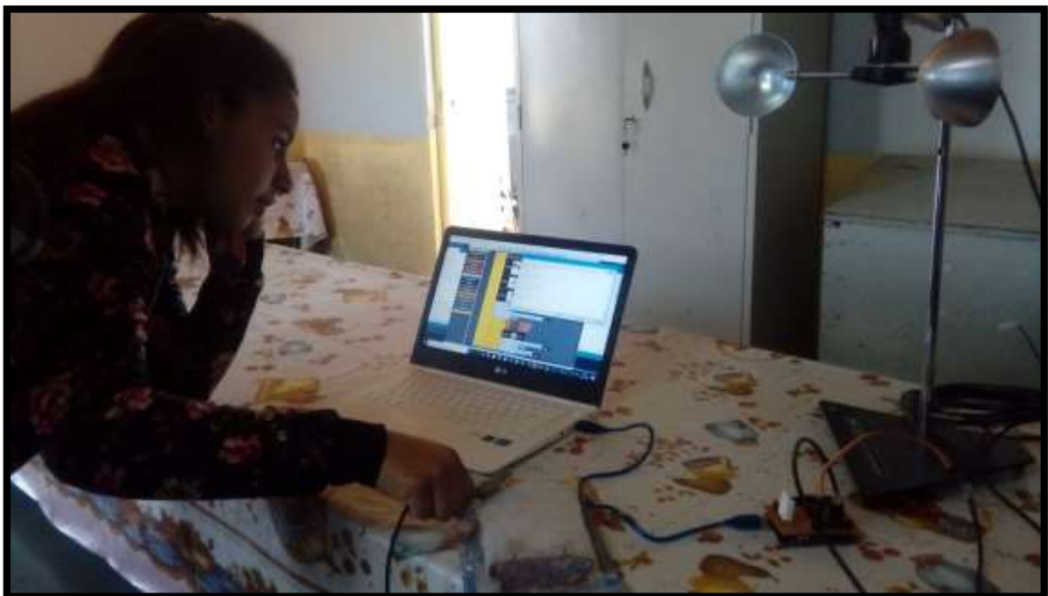
Figura 29 - Medindo o índice de resfriamento utilizando uma barra de gelo para promover a queda na temperatura
