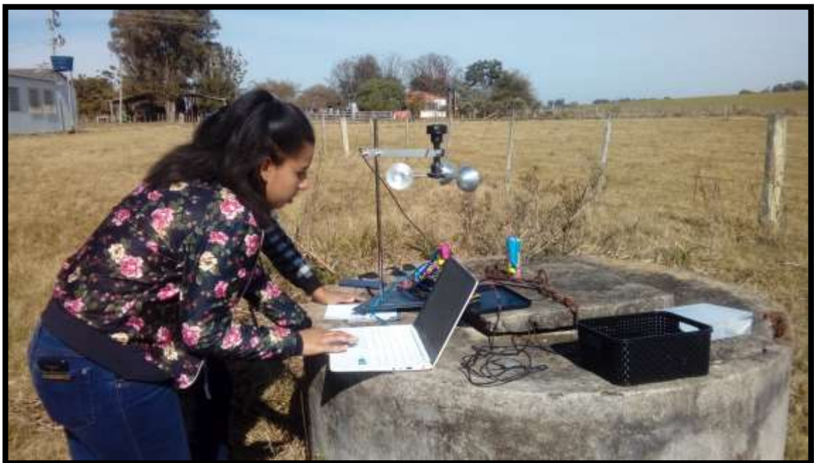
Figura 25 - Testando os sensores de temperatura, velocidade dos ventos, umidade e sensação térmica
