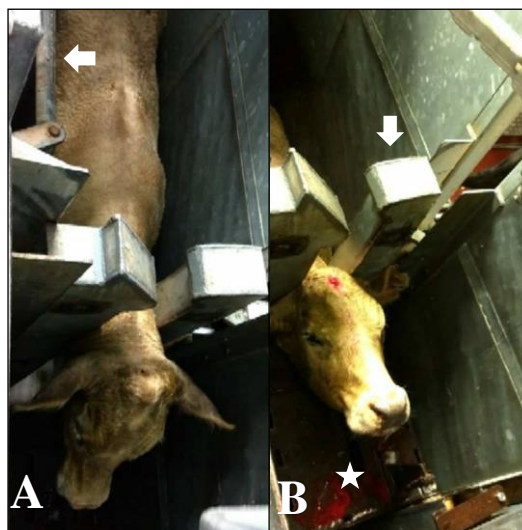
FIGURA 9- A: corpo do bovino contido pela parede móvel indicado pela seta, que reduz o espaço lateral, ajustando o boxe à largura de cada animal. B: cabeça do bovino contida pela “pescoceira” indicado na seta, que prende o animal, impedindo-o de se deslocar dentro do boxe e bandeja indicado pela estrela, que eleva a cabeça do bovino, posicionando-a para dessensibilização. Fonte: arquivo pessoal.
