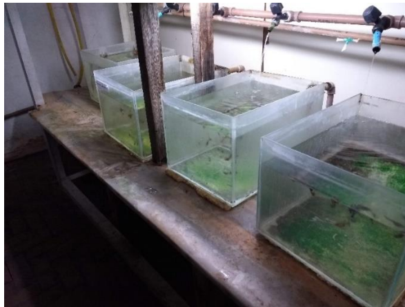
Figura 3: Aquários de criação contendo 26,25 L em Sistema de Recirculação de Água
