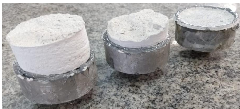
Figura 23 – Tipos de ruptura ocorridos durante o ensaio
