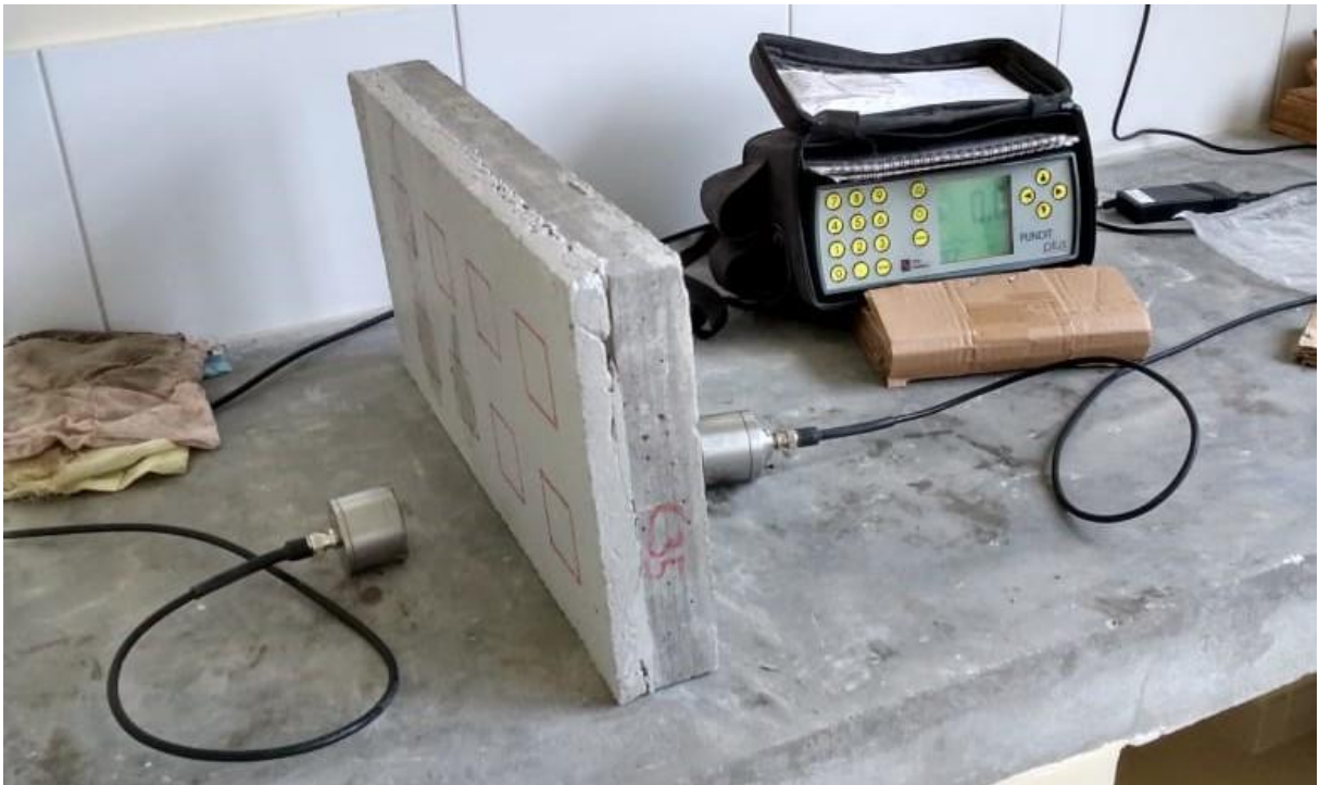
Figura 18 – Medida indireta no ensaio de ultrassom
