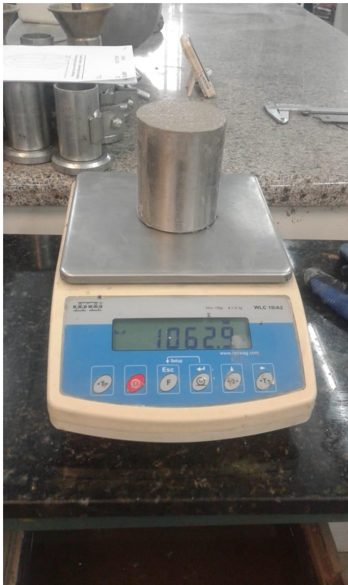
Figura 14 – Determinação da densidade de massa da mistura
