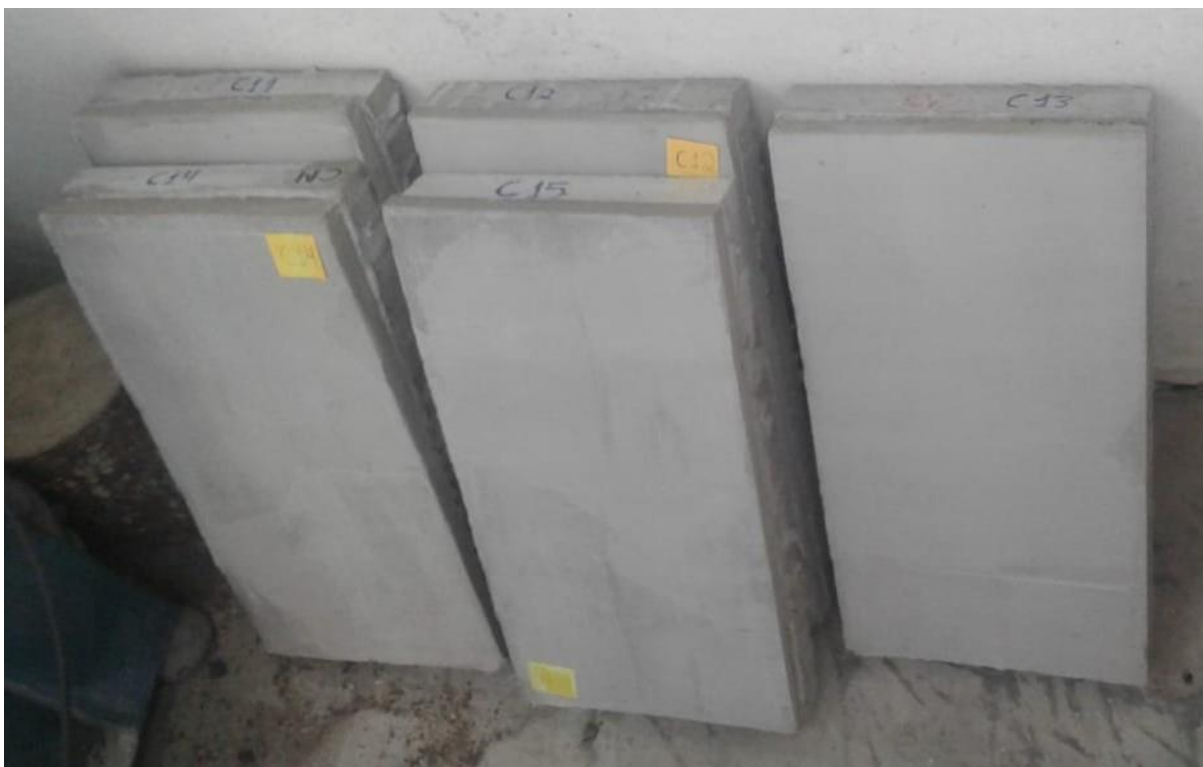
Figura 13 – Placas de concreto e Reboco Médio secando ao ar no laboratório
