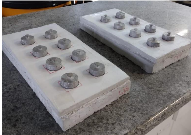
Figura 21 – Pastilhas do arrancamento coladas sobre a superfície
