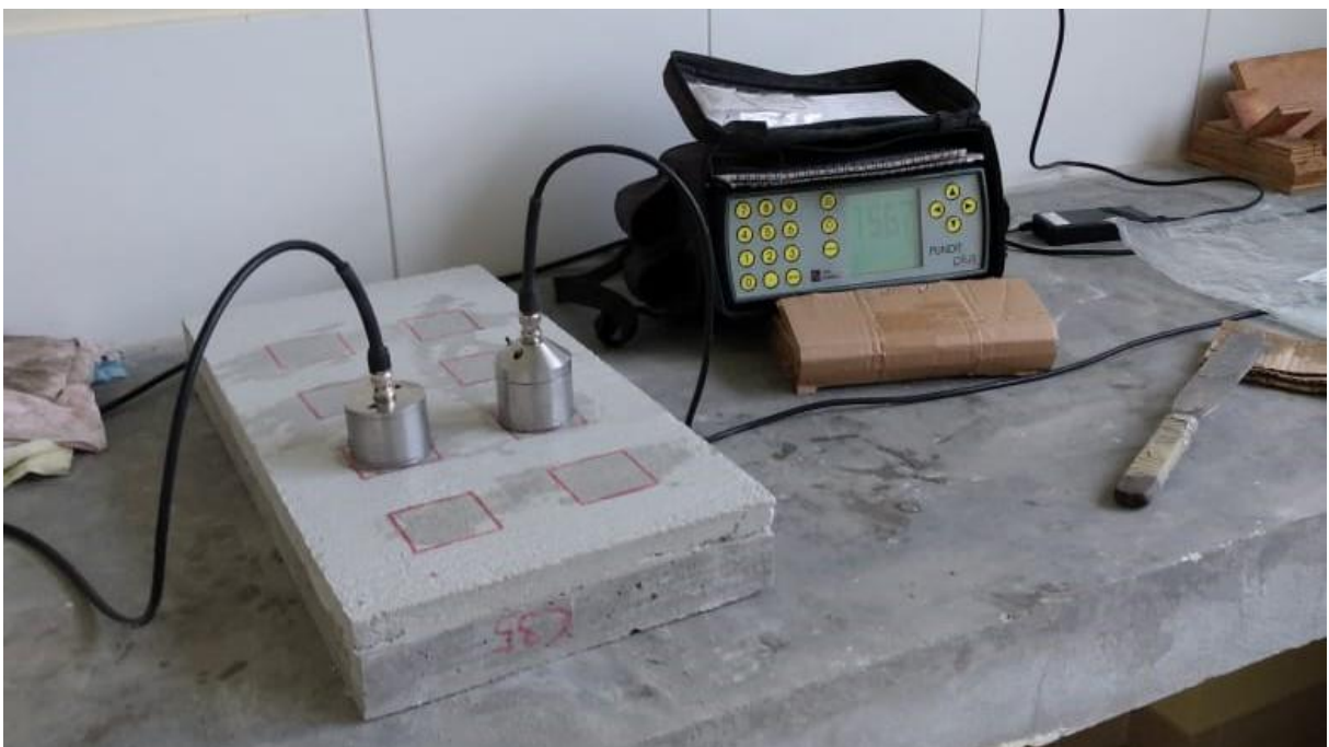
Figura 18 – Medida indireta no ensaio de ultrassom
