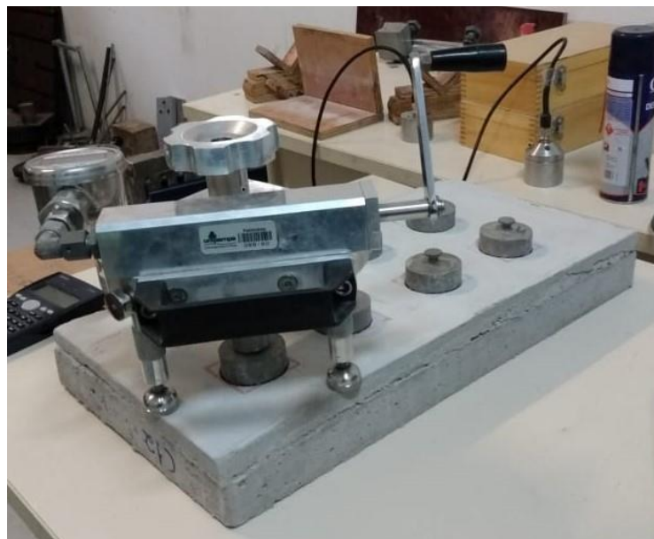
Figura 22 – Equipamento de tração acoplado na pastilha para arrancamento
