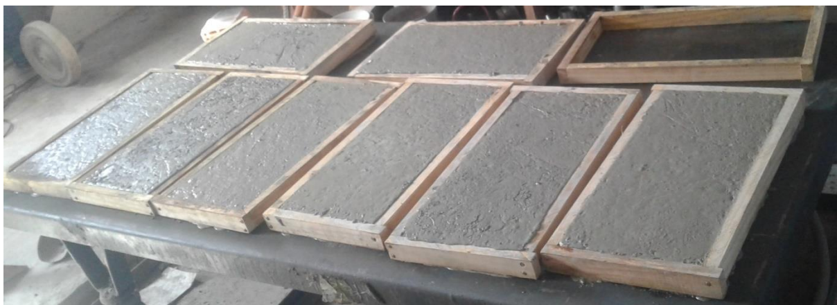
Figura 9 – Concreto nos moldes curando e formando o substrato
