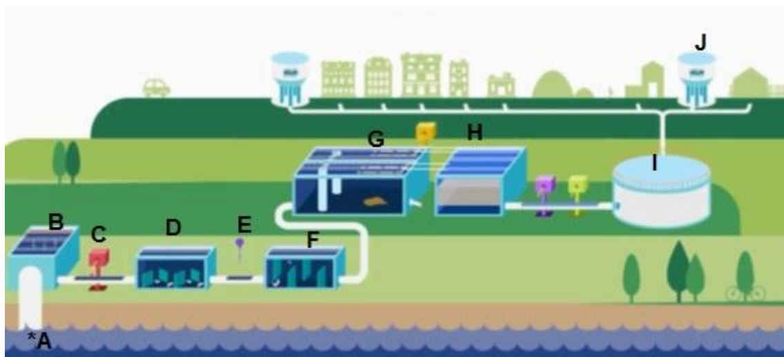
Figura 10. Processo Esquemático do Tratamento de Água ETA SGS
