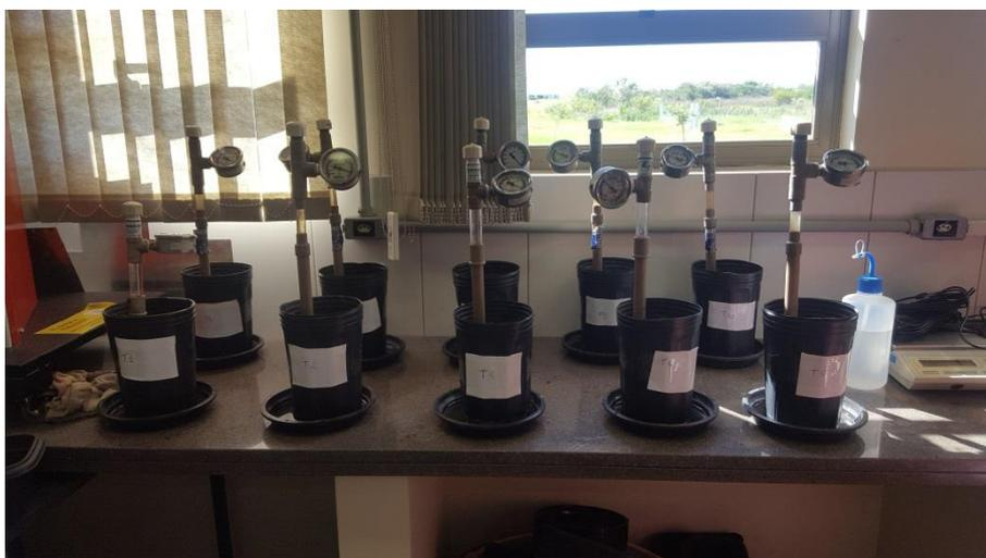
Figura 4 – Calibração dos sensores e tensiômetro no laboratório de hidráulica da Universidade Federal do Pampa, Alegrete, RS, 2019.
