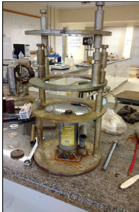
Figura 26 – Macaco hidráulico para compactação estática
