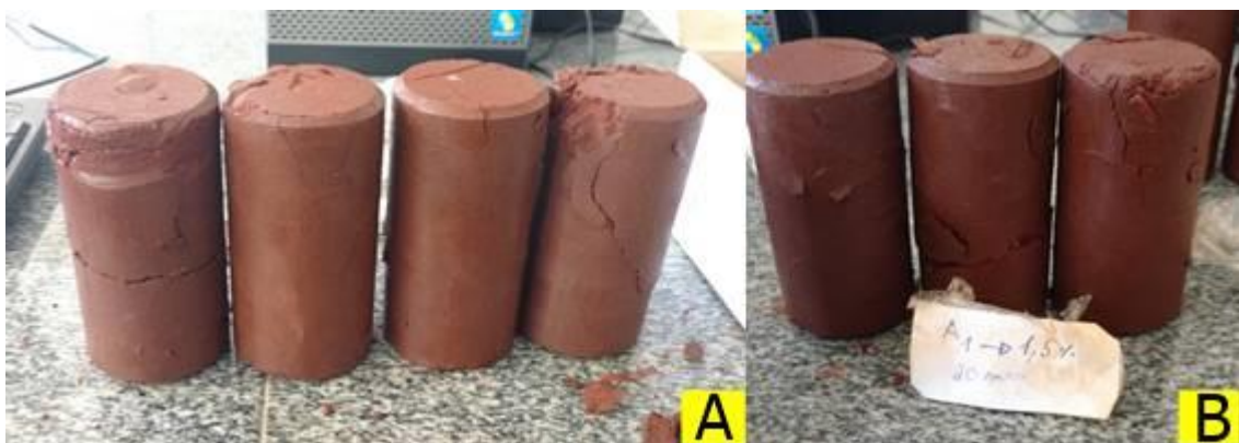
Figura 32 - Amostras de solo + Fibra de 20 mm após ruptura: (A) Adição de 1%; (B) Adição de 1,5%
