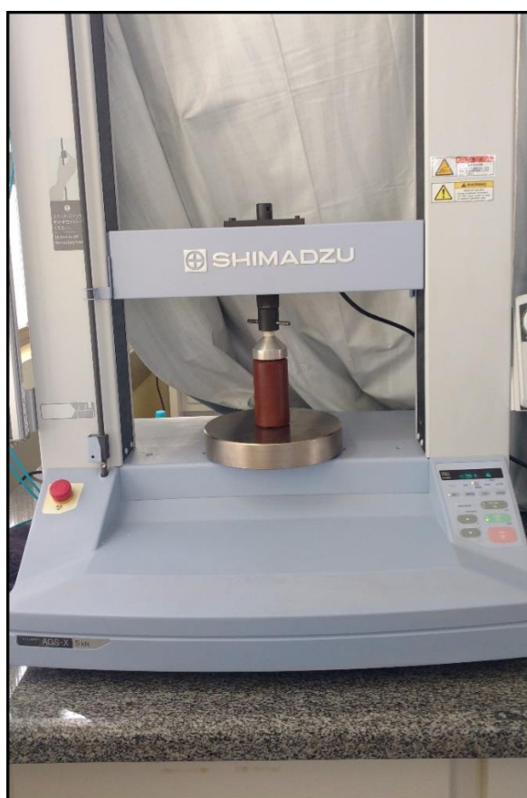
Figura 29 - Equipamento utilizado para os ensaios de resistência à compressão
