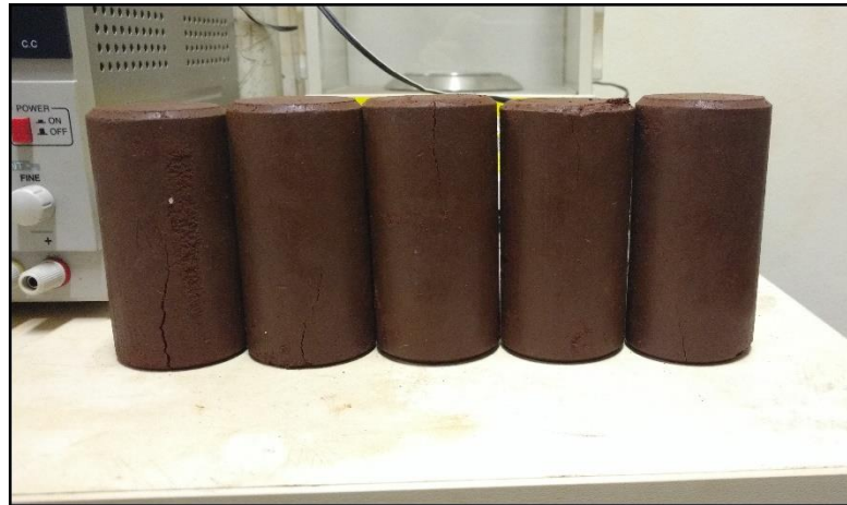
Figura 31 - Amostras de solo + Fibra de 10 mm após ruptura: (A) Adição de 1%; (B) Adição de 1,5%
