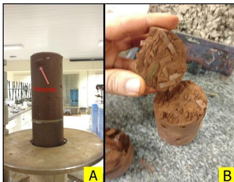
Figura 25 – Amostras com adição de 2%: (A) Amostra após moldagem; (B) Excesso de fibras na mistura de solo+2% de fibra
