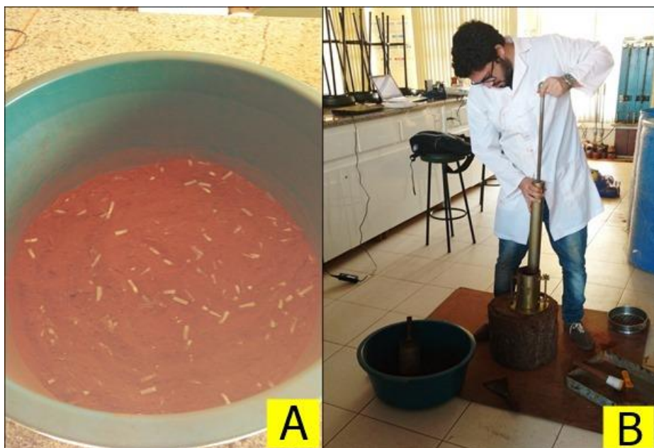
Figura 22 – Execução do ensaio de compactação: (A) Preparação de amostra do solo+fibra; (B) Realização do ensaio
