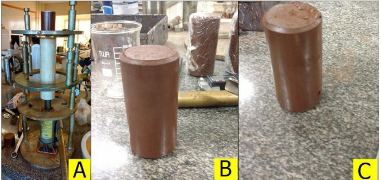
Figura 28 – Moldagem dos corpos de prova: (A) Execução; (B) Solo natural moldado; (C) Solo + 1,5% de Fibra moldado
