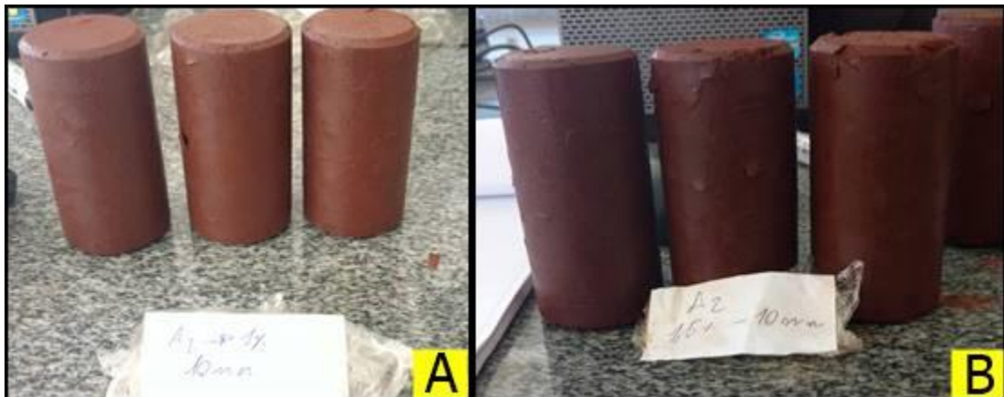
Figura 31 - Amostras de solo + Fibra de 10 mm após ruptura: (A) Adição de 1%; (B) Adição de 1,5%
