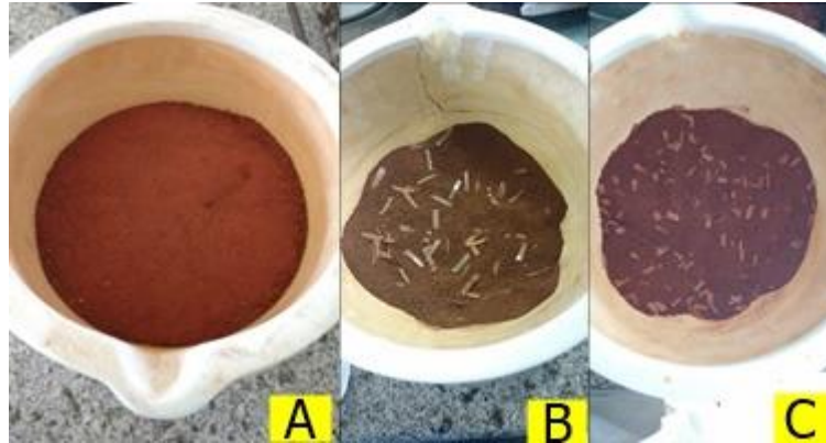
Figura 24 - Misturas realizadas: (A) Solo Natural; (B) Solo + 1% de Fibra; (C) Solo+1,5% de Fibra
