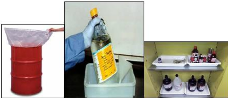
Figura 18: Contêineres e bandejas para contenção de vazamentos.
