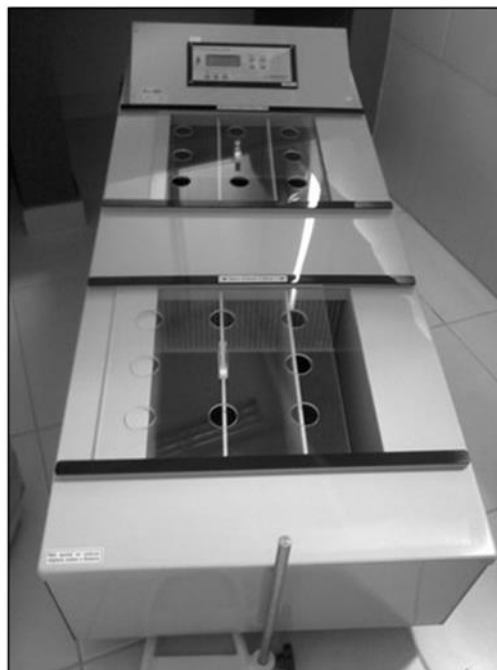
Figura1.7. Esteira motorizada para ratos.
