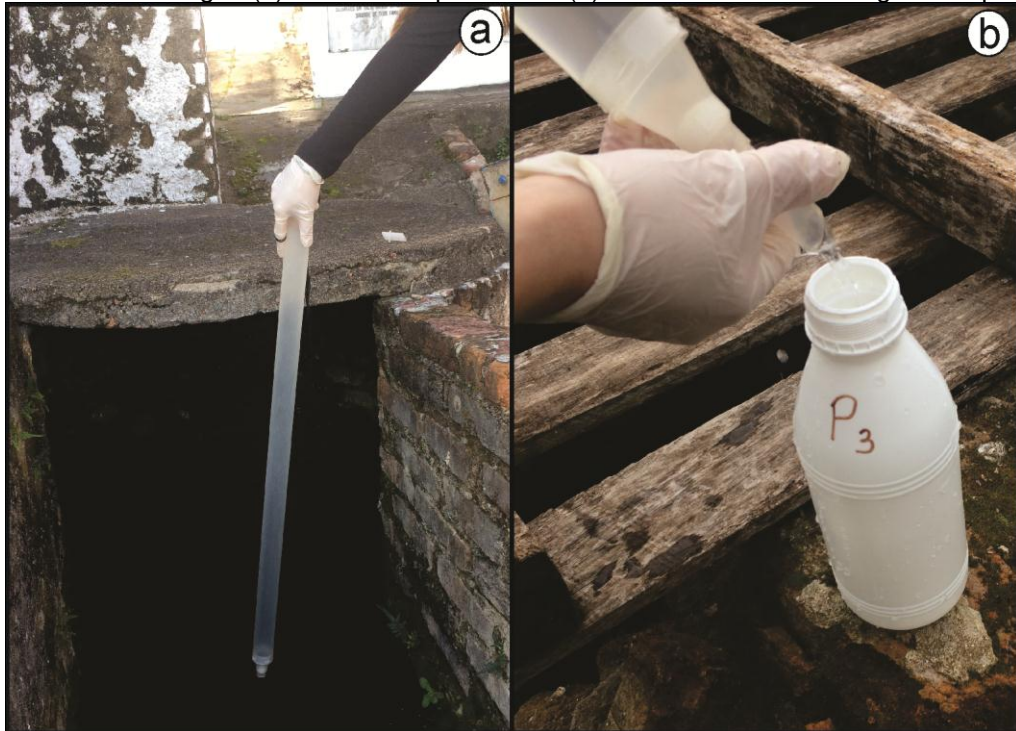
Figura 5 - Coleta de água (a) Coletor do tipo bailer e (b) acondicionamento em garrafas plásticas
