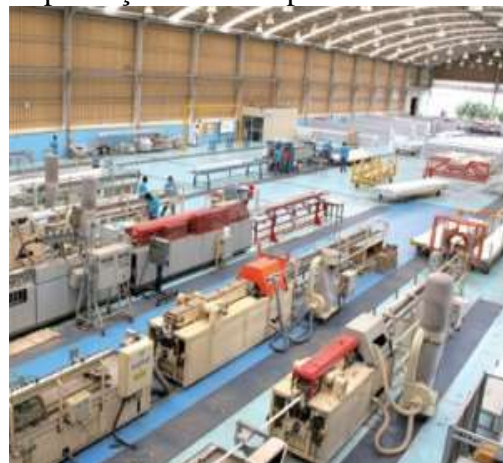
Figura 9- Linha automatizada de produção de tubos plásticos
