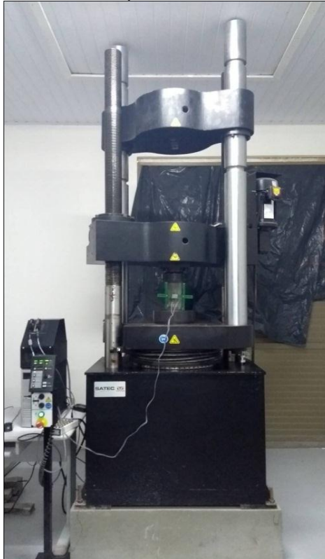
Figura 24 - Prensa hidráulica utilizada para ensaios de compressão axial
