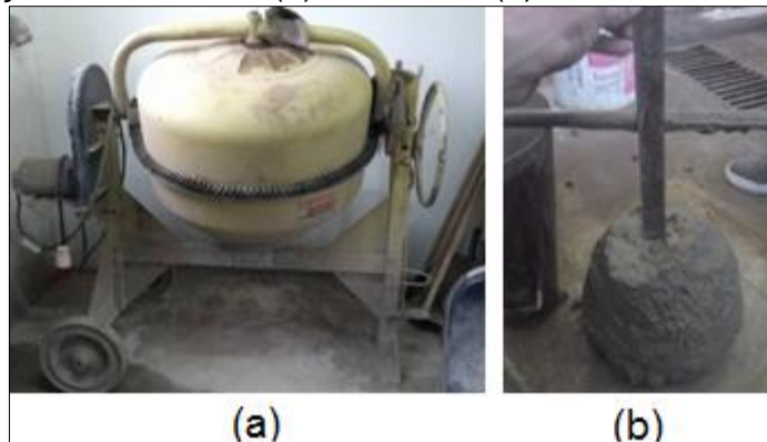
Figura 17 - Produção do concreto: (a) betoneira; (b) ensaio de abatimento
