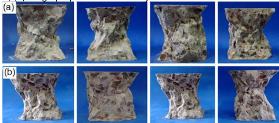
Figura 34 - Ruptura dos corpos de prova do concreto C-30: (a) carga paralela ao lançamento; (b) carga perpendicular ao lançamento
