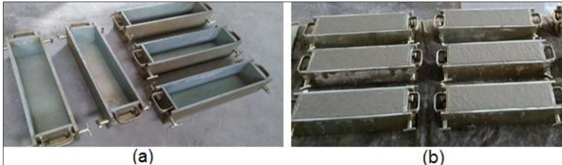
Figura 18 - Moldagem dos corpos de prova: (a) moldes utilizados; (b) moldes após lançamento e adensamento
