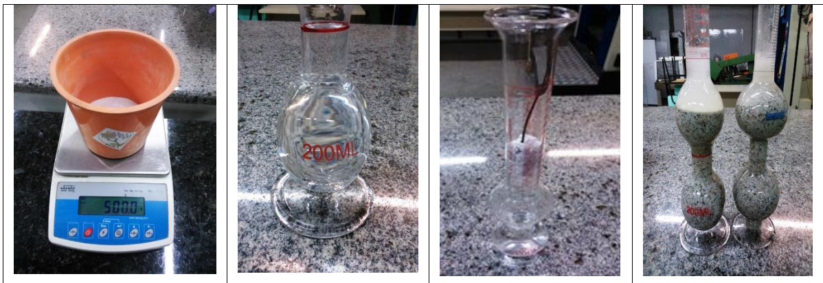
Figura 11: Determinação das massas específicas dos agregados miúdos.
