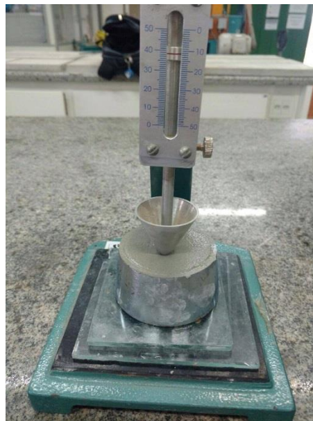
Figura 16: Leitura da penetração do ensaio de Vicat modificado.
