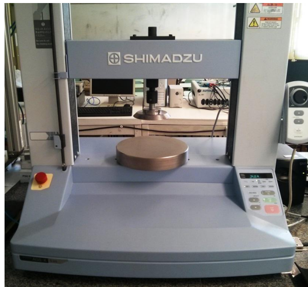
Figura 14: Máquina para o ensaio de squeeze flow.
