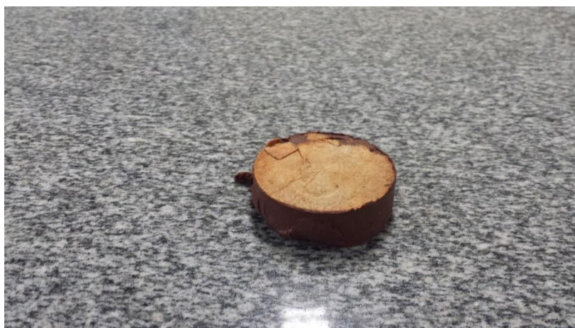
Figura 20-Corpo de prova, com papel filtro, após ensaio
