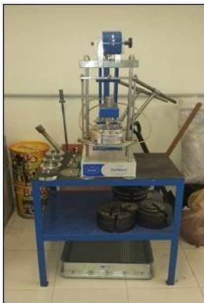
Figura 19– Aparelho de ensaio de adensamento unidimensional
