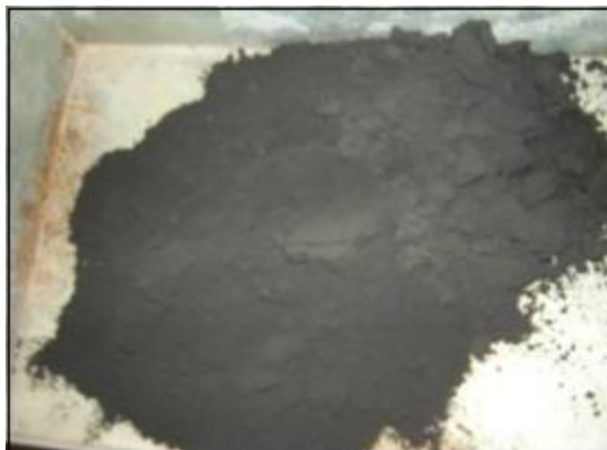
Figura 16-Cinza da casca de arroz, após ser moída
