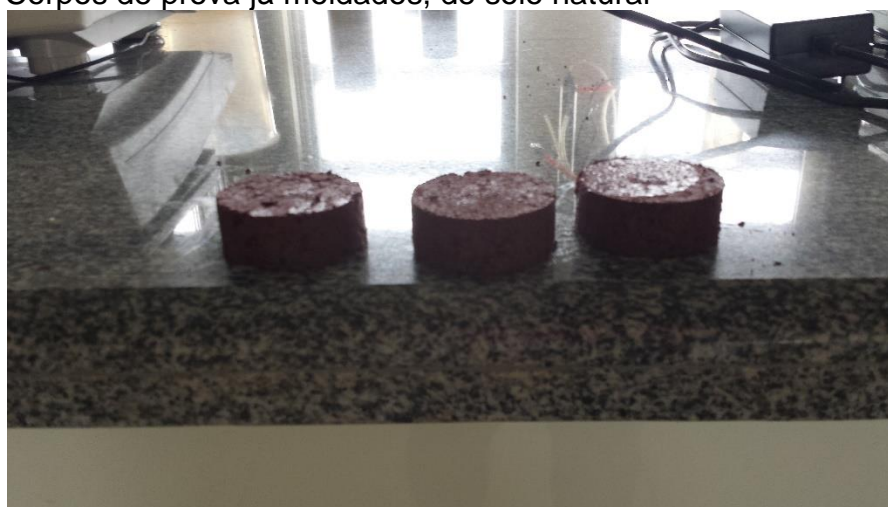
Figura 18-Corpos de prova já moldados, de solo natural
