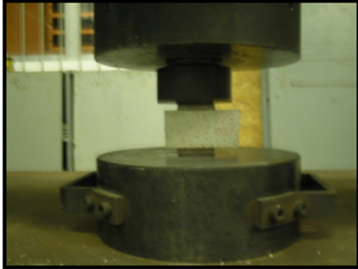
Figura 10 – Ensaio para determinar a resistência à compressão
