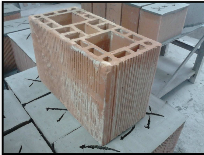
Figura 12 – Blocos com paredes vazadas e fases ranhuradas – 7 MPa
