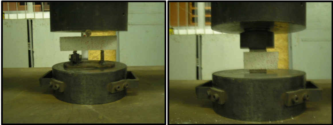
Figura 14 – Ensaio de tração na flexão e compressão
