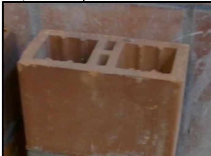
Figura 13 – Bloco com paredes maciças e fases lisas – 10 MPa
