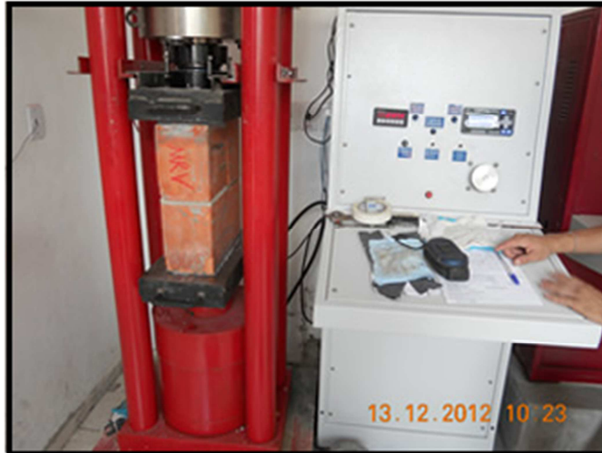
Figura 11 – Ruptura do prisma
