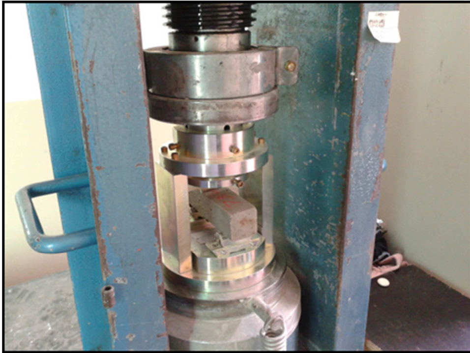
Figura 9– Ensaio para determinar a resistência à tração na flexão
