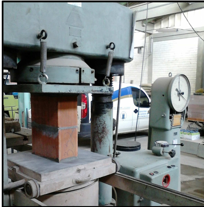
Figura 15 – Prisma rompido na prensa hidráulica aos 28 dias
