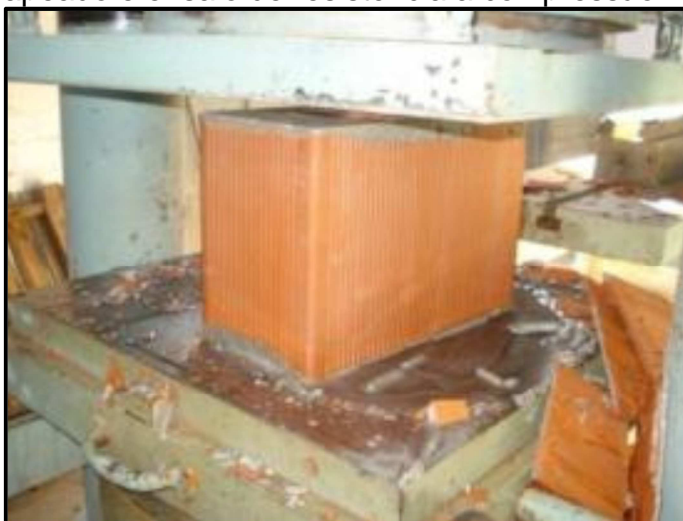
Figura 8 – Bloco capeado e ensaio de resistência a compressão
