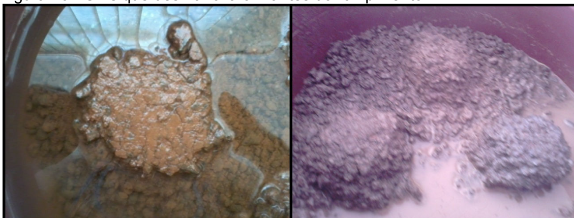
Figura 26 - CP's que desmancharam antes do rompimento
