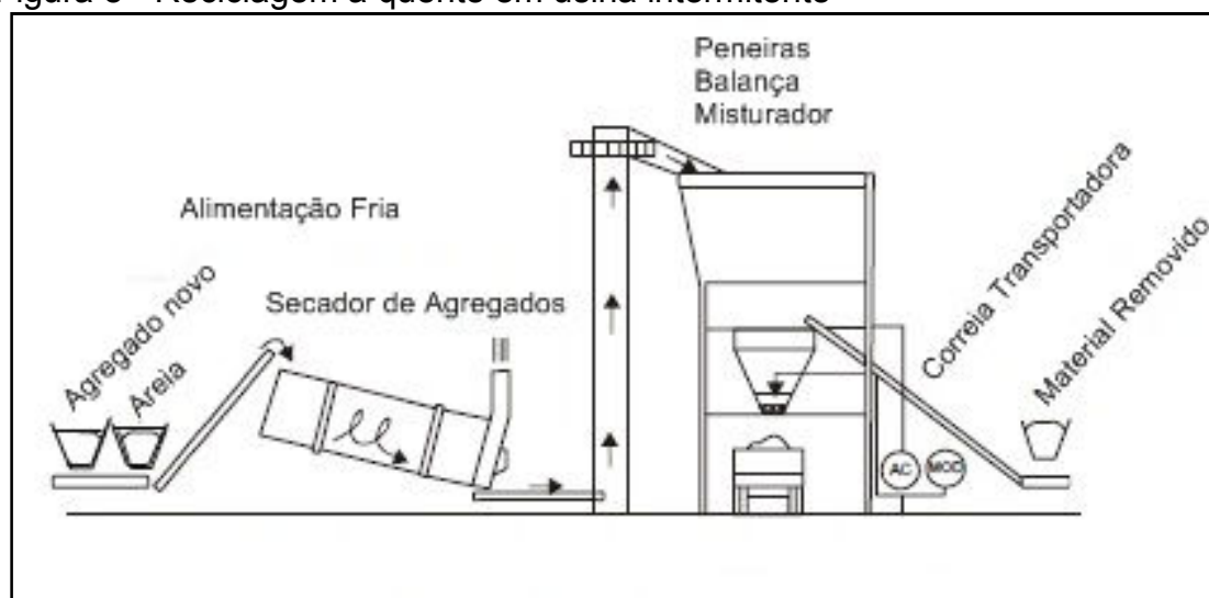
Figura 8 - Reciclagem a quente em usina intermitente
