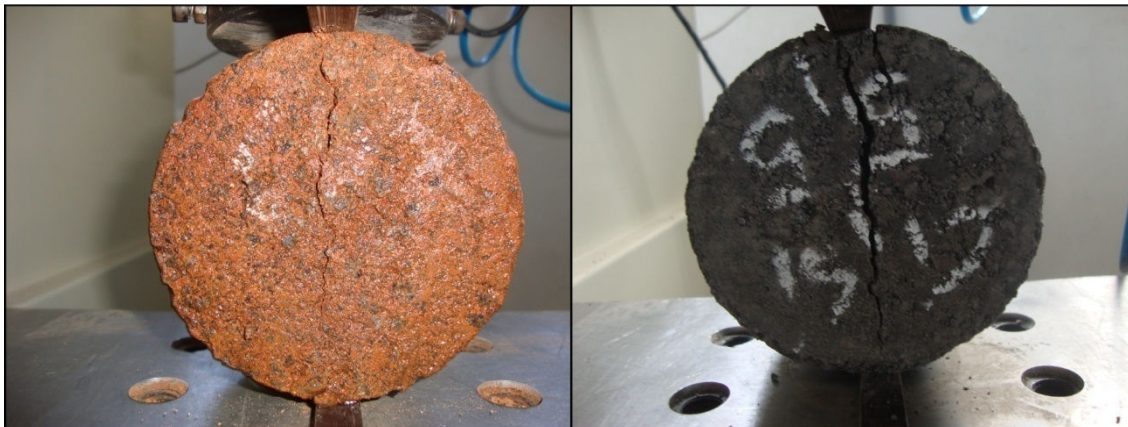
Figura 25 - Fissuração do CP no momento da ruptura
