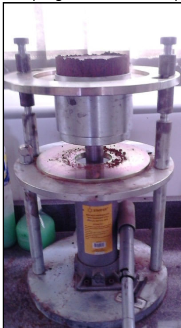
Figura 21 - Macaco hidráulico tipo garrafa utilizado para desmoldagem
