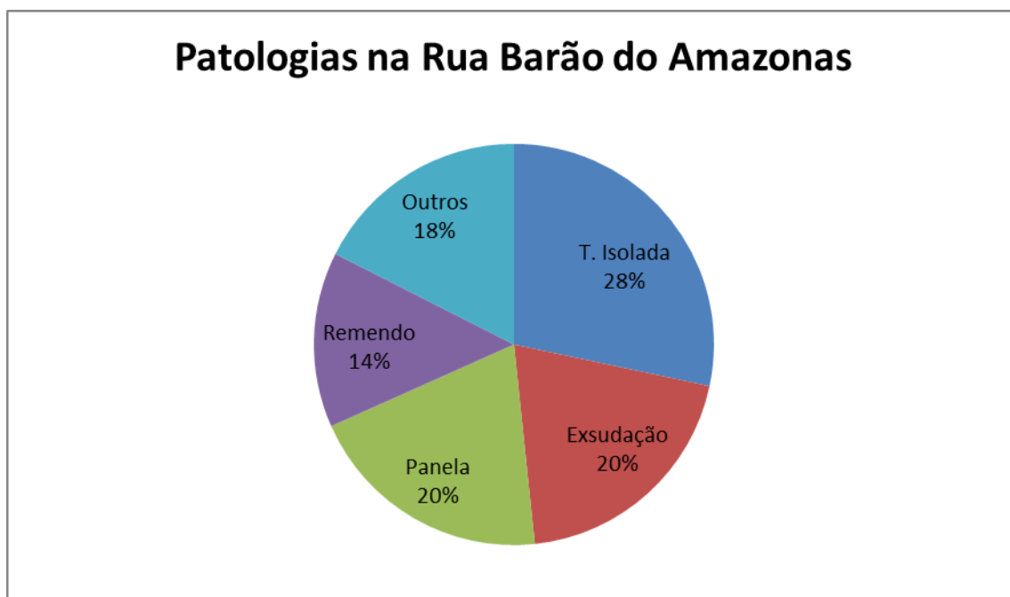
Figura 56 – Percentual de patologias na Rua Barão do Amazonas
