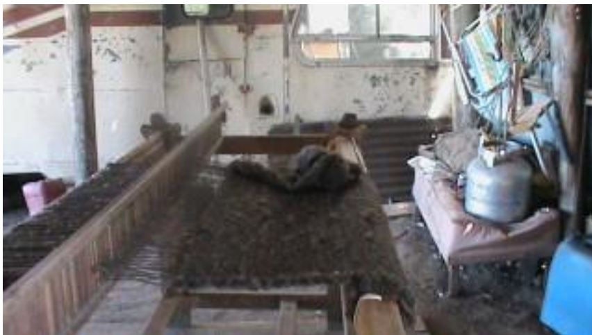
Foto 8. Tear manual onde são produzidos xergões e cobertores. Imagem reproduzida pela autora.
