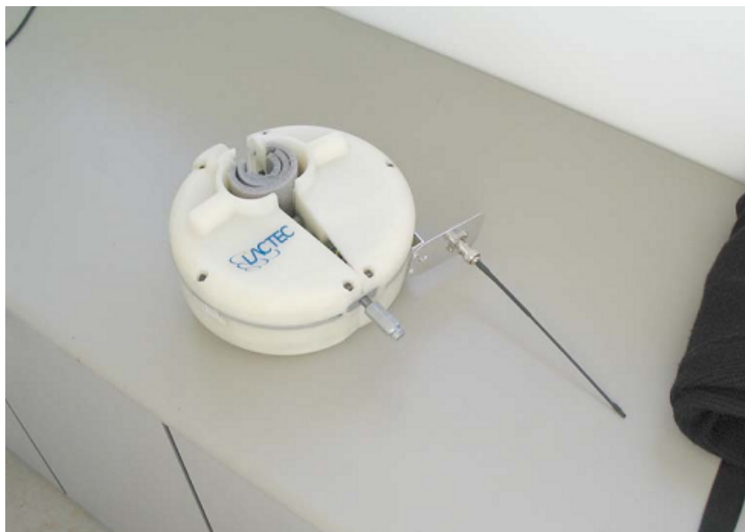
Figura 10 – Sensor de corrente com comunicação via rádio (NETO, 2005).
