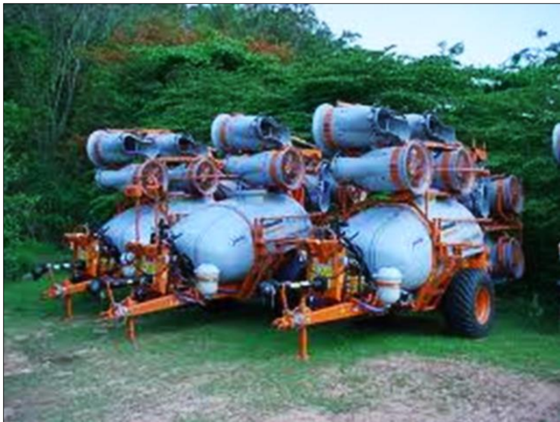
Figura 1.4 – Torre sobreposta ao reservatório para transporte
