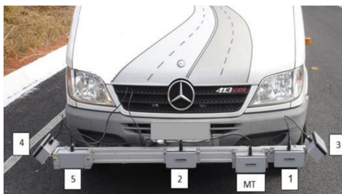
(b) Barra com sensores para medida de irregularidade (1, 2, 5), sensores para medida de afundamento de trilha de roda (1, 2, 3, 4 e 5) e sensor para medida de macrotextura (MT)
