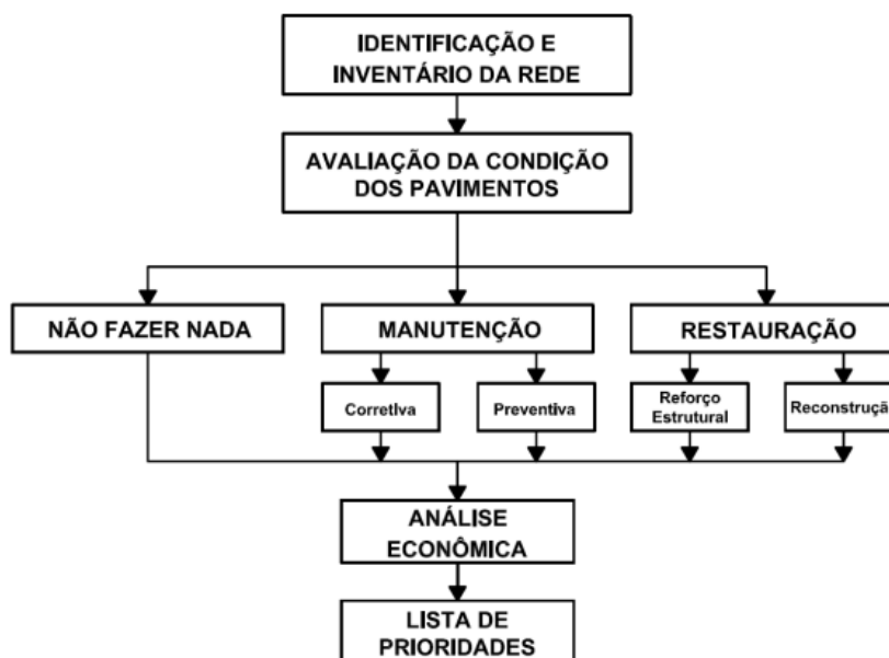
Figura 7 – Fluxograma de um SGP com alternativas das estratégias de M&amp;R
