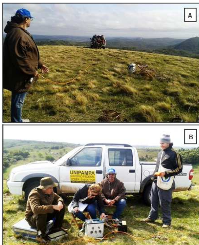
Figura 4 - Preparação para a aquisição dos dados de eletrorresistividade por caminhamento elétrico em região acidentada (A). Em (B) preparação dos comandos para início da aquisição dos dados pelo arranjo Wenner-Schlumberger.
