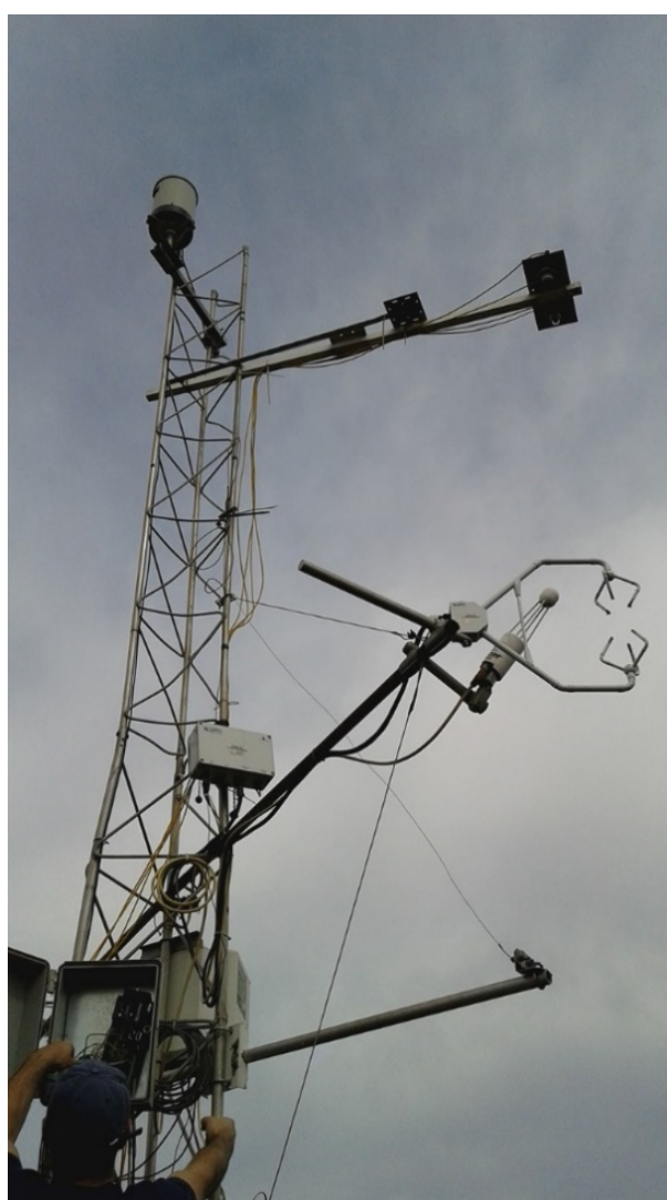
Figura 6 – Torre micrometeorológica do sítio de Cachoeira do Sul. Visão do anemômetro sônico e dos analisadores de gás para o sistema Eddy Covariance.
