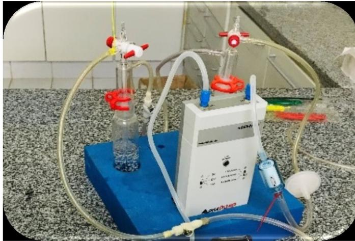
Para realização das medidas de  $Rn^{222}$  na água é utilizado o *Aquakit* (Figura 10) que contém: uma espuma de apoio; filtro de segurança; tubo de degaseificação ( 100ml); tubo de segurança (100ml), seringa plástica e três e três mangueiras ( GENITRON,2007).
