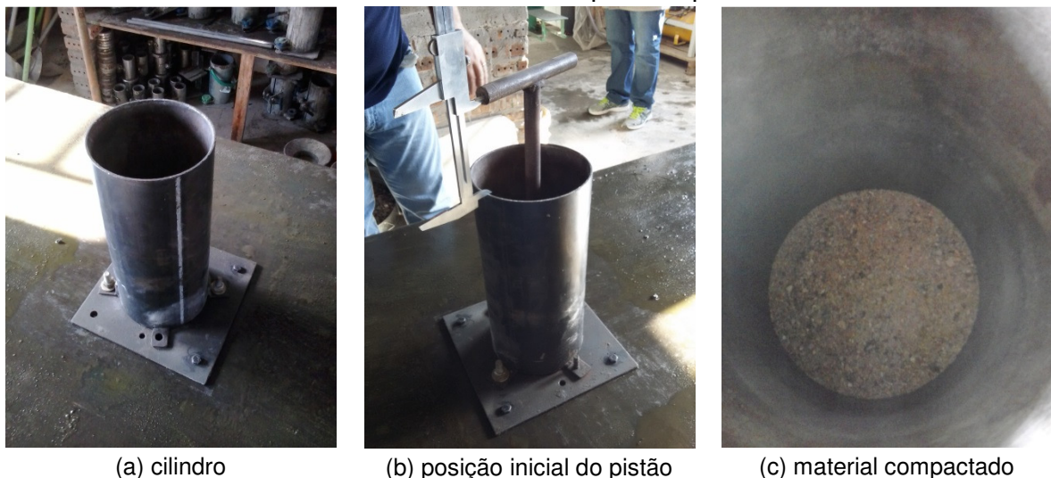
FIGURA 25 – Procedimento do ensaio de compacidade para agregados com dimensões maiores que 100 µm
