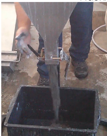
(a) Medição do tempo após a liberação concreto
