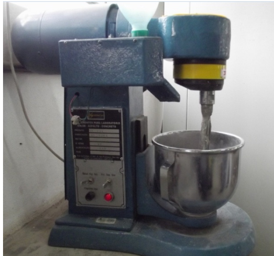
FIGURA 24 – Misturador de bancada utilizado no ensaio de demanda de água
