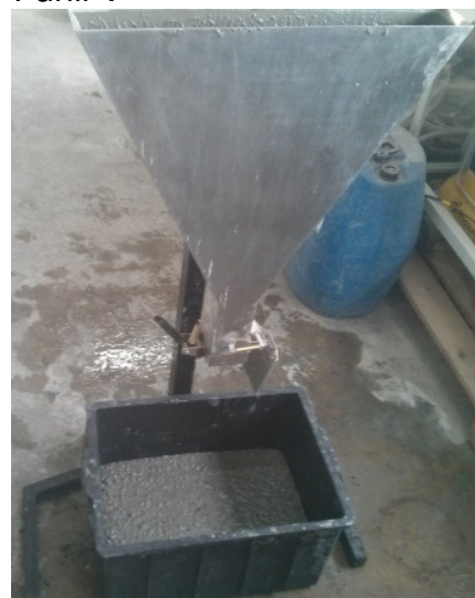
(b) Concreto na caixa após fluir pelo Funil V
