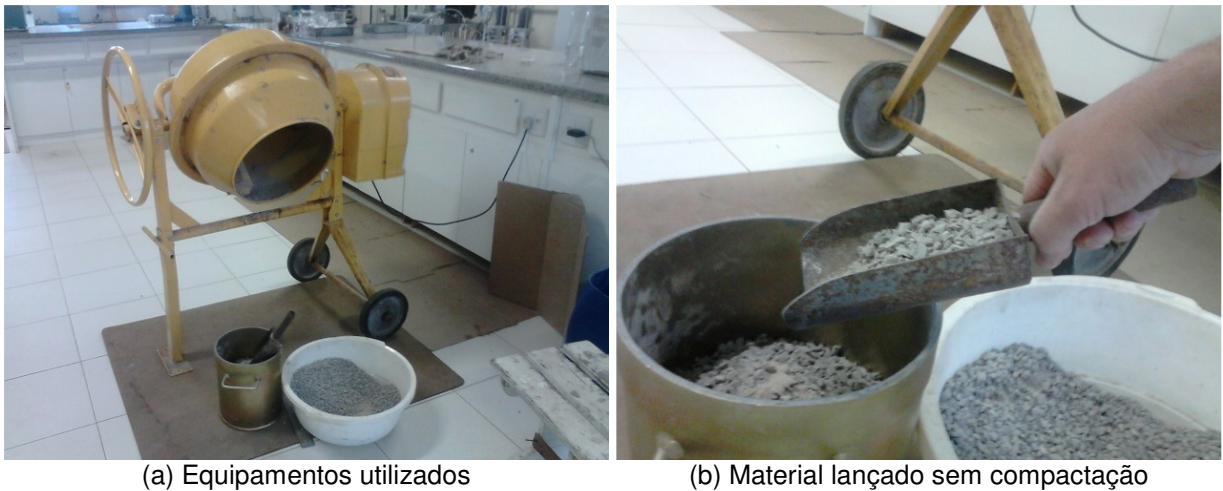
FIGURA 22 – Realização do ensaio de determinação do esqueleto granular
