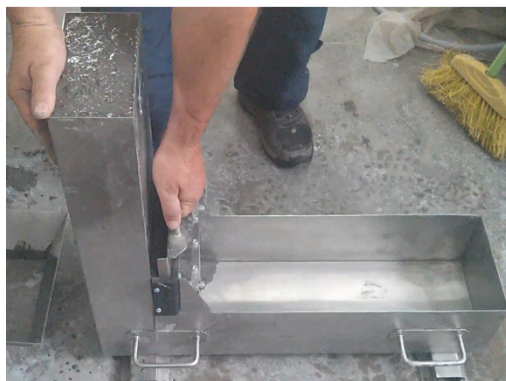
(a) Caixa L preenchida com concreto
