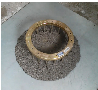
(c) Concreto espalhando entre os obstáculos
