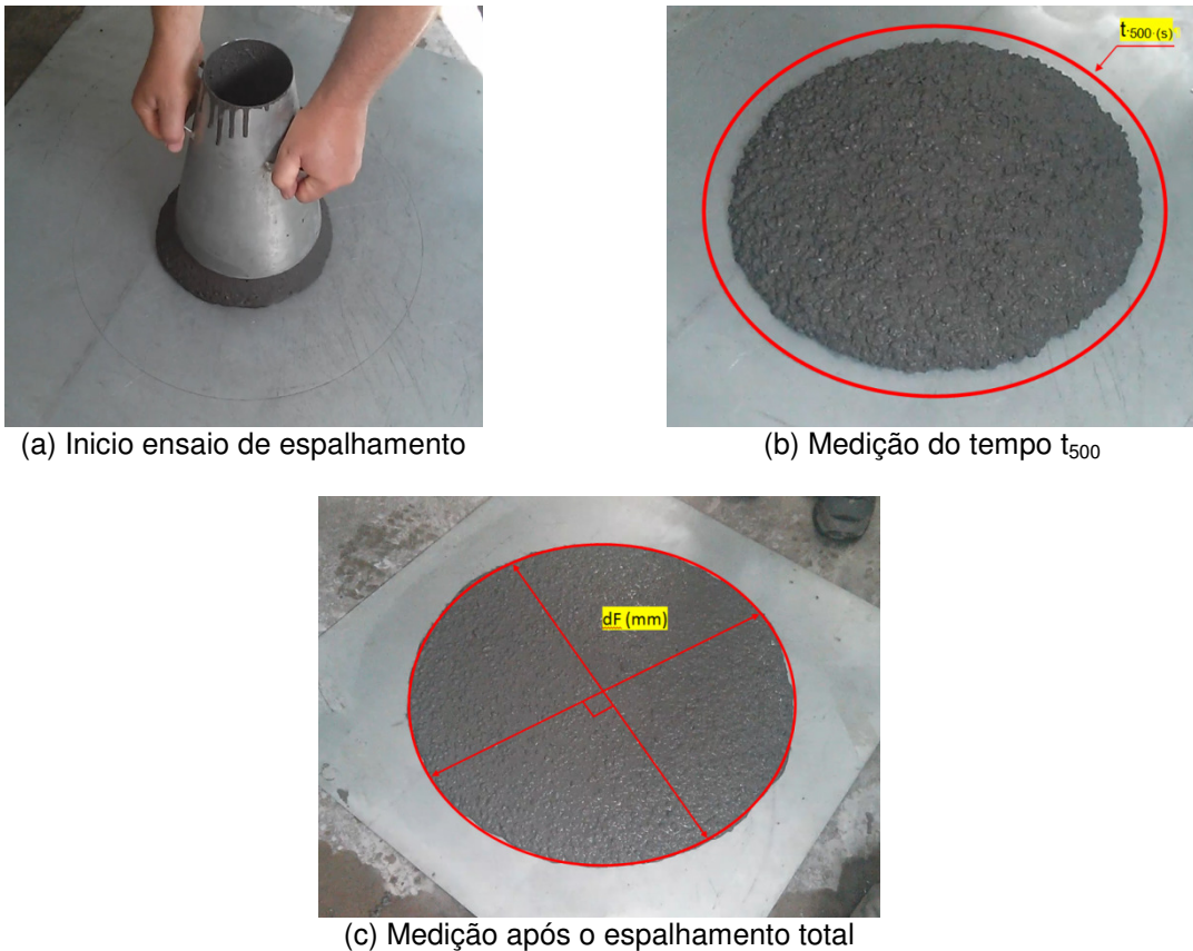
FIGURA 30 – Ensaio de espalhamento pelo Cone de Abrams
