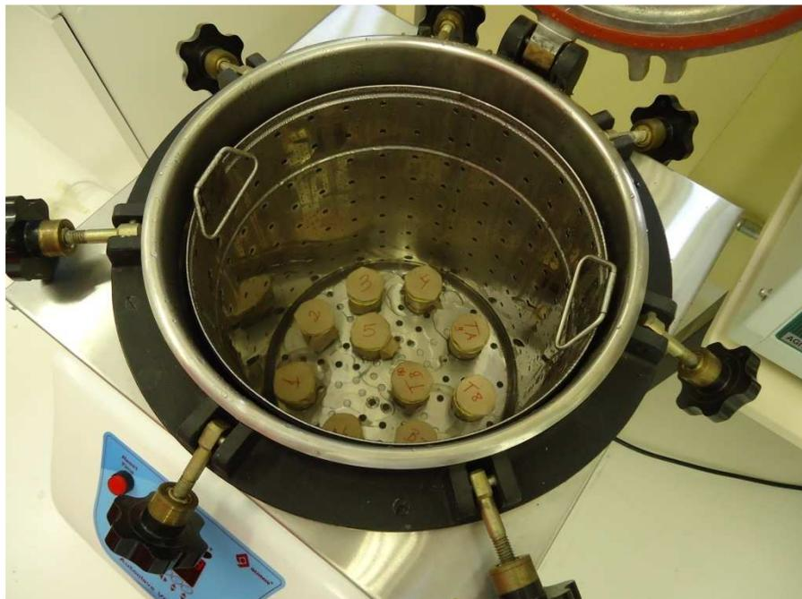
FIGURA 3.2 - Amostras de casca de arroz em solução sendo autoclavadas.
