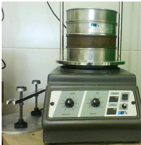
FIGURA 3.1 - Agitador eletromagnético com peneiras redondas Bertel.
