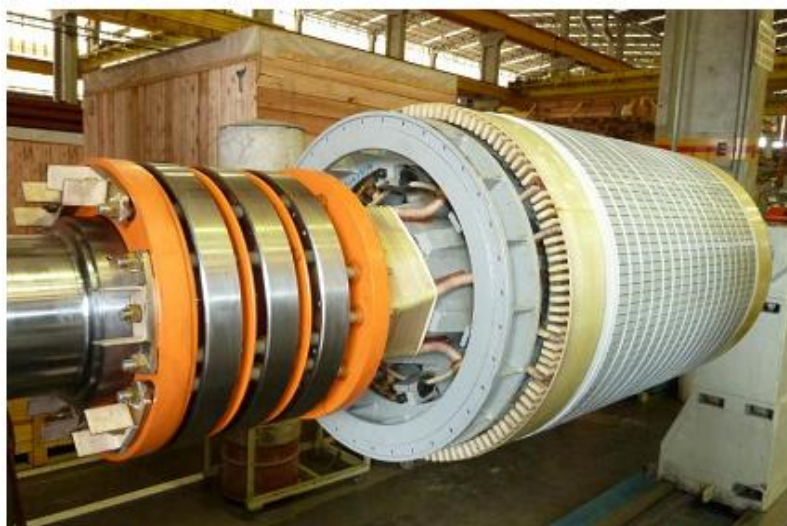
FIGURA 4.1: Rotor bobinado com o conjunto de anéis de deslizamento.
